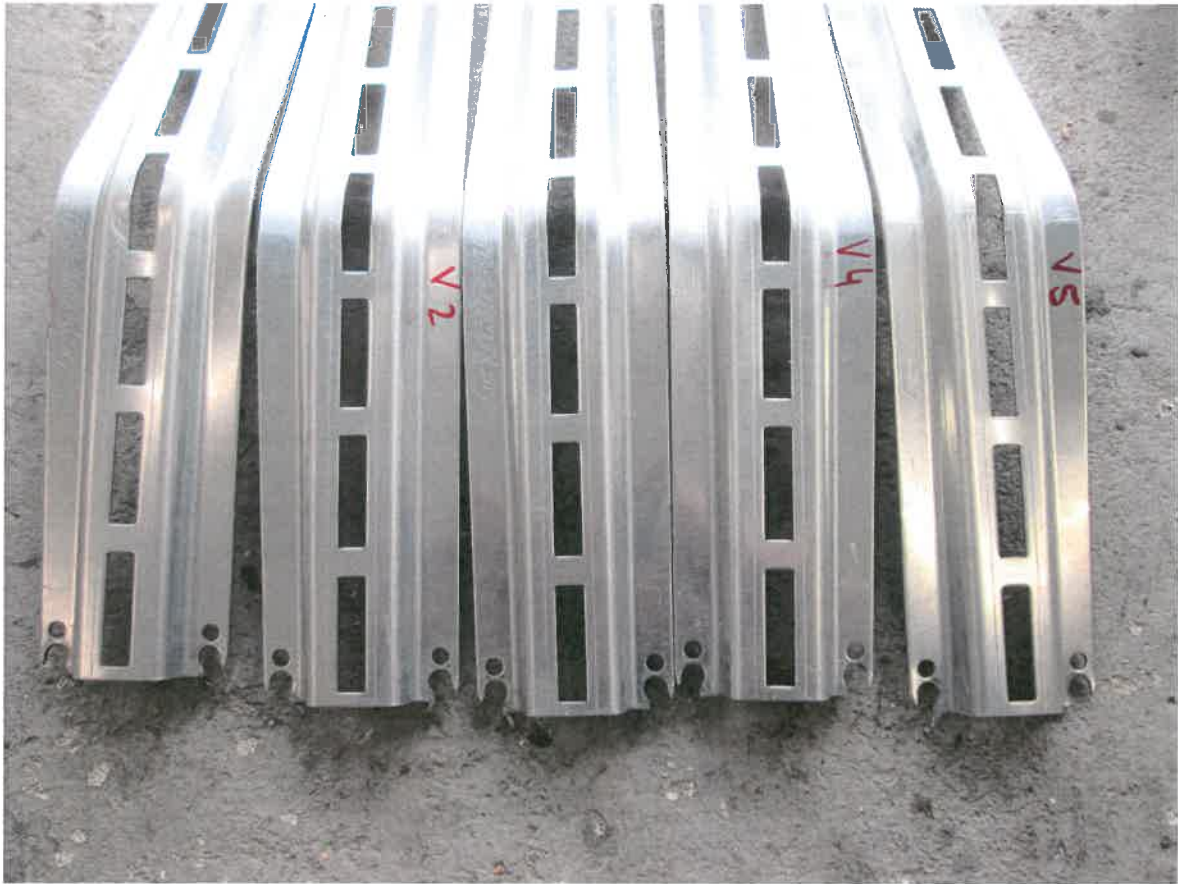
Bild 20 Exemplarisch: Prüfreihe mit LP 650 und sichtbaren Bruch des Profils
