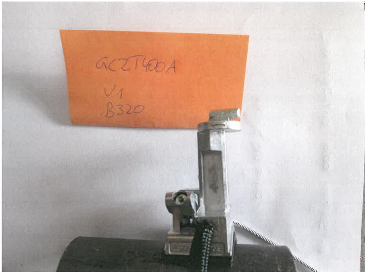
Bild 11 Exemplarisch: Bruch an der Drehverkeilung (hier: GC2T400A )
