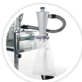
goed doordacht filtersysteem voor een gesloten stofkringloop
