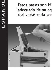
Limpieza de las terminales del emisor localizadas abajo de la tapa principal. Para llevar a cabo este procedimiento, **APAGUE EL EQUIPO**. Desatornille y levante la tapa del equipo, utilizando un algodón o un paño suave, remueva con cuidado todo el polvo y suciedad que se haya acumulado en las terminales de ambos lados. Tenga cuidado ya que las terminales están muy filosas.
