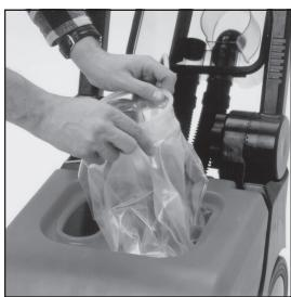
☞ Lyft renvattentank påsen och haka den ur påfyllningsöppningens krage. Lägg tillbaka påsen i tanken och ta ur den genom den större tanköppningen. Töm och spola ur påsen med rent vatten.
