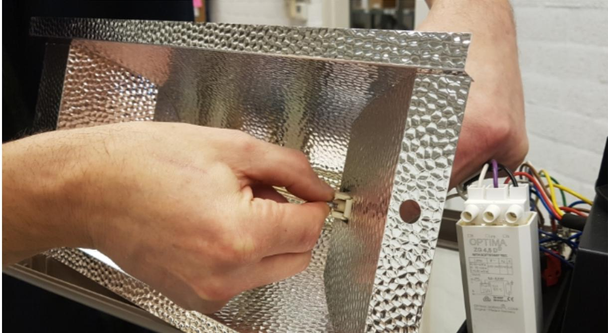
NL: Verwijder de lamp door aan de achterzijde de fitting open te trekken en aan de lampzijde de lamp juist in tegengestelde richting te drukken.
