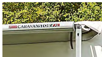
Montage op kanaalbaan
