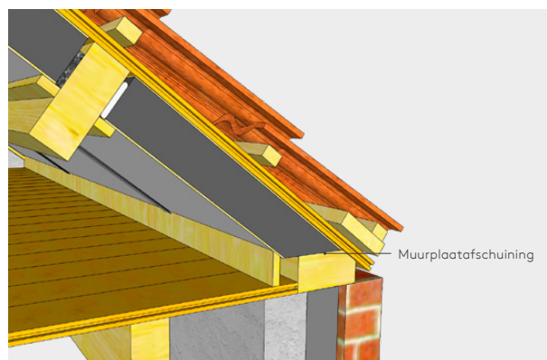
Figuur 2 - Detail muurplaatafschuiving
