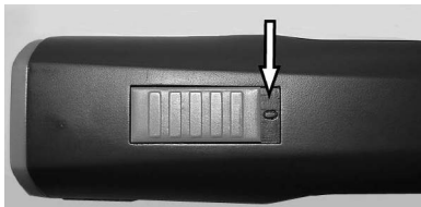
Fig. 4 Interruptor em posição OFF ("0")
