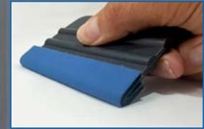
Die abgerundete Kante des Rakels wird dicker gemacht und eignet sich daher sehr gut für tiefe Sicken an Firmenwagen und Transportern. Falls nötig, Buffer anfeuchten, um Kratzer zu vermeiden.
