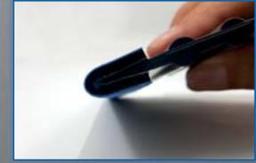
Robustes Alcantara mit einer 3mm starken Schwammschicht Perfekt fürs Folieren in Vertiefungen und Sicken, da die Folie hiermit leicht an die Karosserieform angepasst werden kann.
