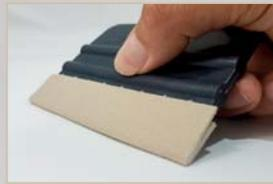
Die 3mm starke Schwammschicht rundet den Rakelrand ab und verteilt den Druck über die volle Breite. Falls nötig, Buffer anfeuchten, um Kratzer zu vermeiden.
