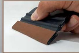
Die 2mm starke Schwammschicht rundet den Rakelrand ab, macht ihn dicker und verteilt den Druck über die volle Breite. Falls nötig, Buffer anfeuchten, um Kratzer zu vermeiden.
