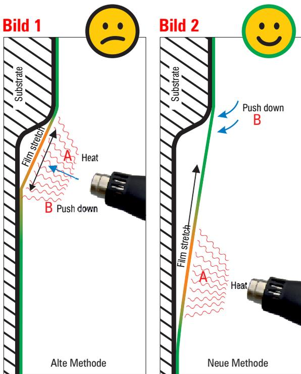
In Bild 2 und 3 wird die Spannung verschoben, indem die Folie in dem Teil erwärmt wird, der nicht verformt werden muss. Sobald die Folie beim Erwärmen erweicht (A), wird der Teil, der verformt werden soll, angedrückt (B). Die Folie dehnt sich an dieser Stelle nicht aus und hat eine maximale Haftfestigkeit und Adhäsionskraft, immer Tempern!
