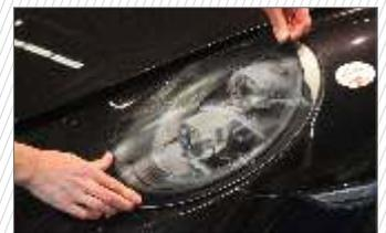
PremiumShield® SMOKE wurde entwickelt, um Scheinwerfern und Rückleuchten ein etwas dunkleres Aussehen zu verleihen und gleichzeitig alle Vorteile des Schutzes vor Kratzern, Stößen und Steinschlag zu bieten. Der Film ist vollkommen glasklar und verzerrt die Lichtstrahlung nicht.
