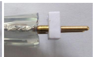
Vista laterale del connettore a 2 perni
