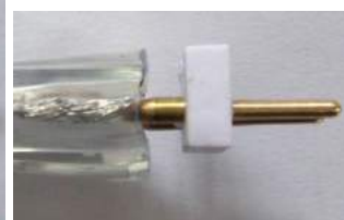
Widok z przekroju po mocowaniu 2 piniowego łącznika
