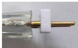
Vista lateral tras asegurar el conector de 2 pines
