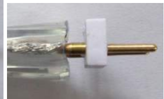
Seitenansicht nach Sicherung des 2-Pin Steckers
