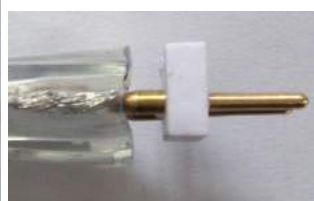
Vista lateral após a fixação do conector de 2 pinos
