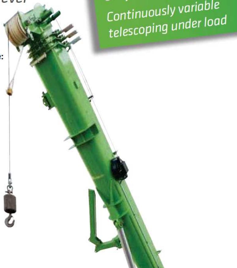
Stufenloses Teleskopieren unter Last
