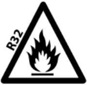
Dieses Gerät enthält fluorierte Treibhausgase in einem hermetisch geschlossenen System. Die Installation, Instandhaltung, Reparatur oder Entsorgung sind nur von professionellen und qualifizierten Technikern durchzuführen, entsprechend der zugehörigen Kapiteln in dieser Bedienungsanleitung. Nachfüllen des Gases darf nur durch eine Fachkraft mit einem R32 Betriebserlaubnis geschehen. Vor und nach der Installation soll die Gasdichtigkeit kontrolliert werden.
