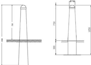
Extra: Version amovible au moyen d'un socle en acier galvanisé. Mécanisme de fermeture composé d'un axe fileté en inox, de 16 mm de diamètre et d'un écrou de verrouillage en bronze. Le verrouillage s'effectue à l'aide d'une clé (fournie) par une ouverture dans la tête sphérique.
