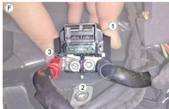
**TABLE F1 - FASTENING CABLES ON STARTER RELAY**
