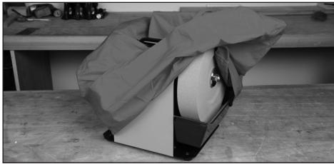
Houdt stof en vuil verwijderd van de natte slijpmachine wanneer deze laatste niet in gebruik is.
