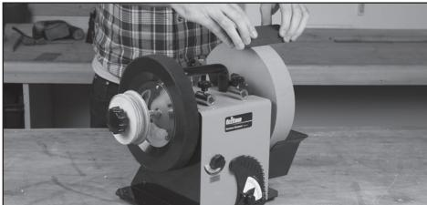
Zum Abrichten des Schleifsteins. Grobe Körnung: 220; feine Körnung: 1000 (Gebrauchshinweise im Abschnitt „Steinpräparierer verwenden“).
