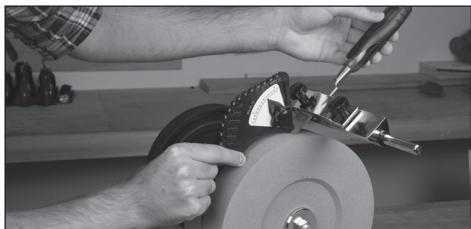
Para ajuste do ângulo correto de amolação. Permite a amolação precisa e repetida em ângulos de chanfro específicos (Para instruções de uso, consulte 'Uso da Guia de ajuste do ângulo de amolação').
