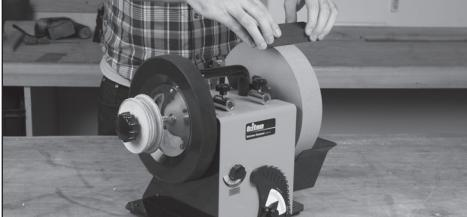
Pour rectifier la meule afin d'obtenir une finition parfaite. Grain gros 220. Grain fin 1 000. (Pour les instructions d'utilisation propres au prépare-meule, voir 'Comment utiliser un prépare-meule').
