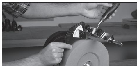
Позволяет задавать нужный угол настройки. Обеспечивает стабильную точность при шлифовании фасок со специальным углом. Инструкции по применениюсмотрите в разделе «Применение приспособления для настройки угла шлифования».
