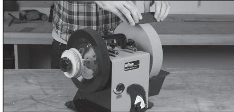
Voor het conditioneren van de slijpsteen. Ruw 220 korrelgrootte. Fijn 1000 korrelgrootte. (Voor gebruiksinstructies, zie: "Gebruik van de steenlijper")
