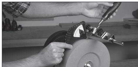
Indicado para ajustar el ángulo de afilado de las piezas de trabajo. Véase la sección "Utilización de la guía de ángulo".
