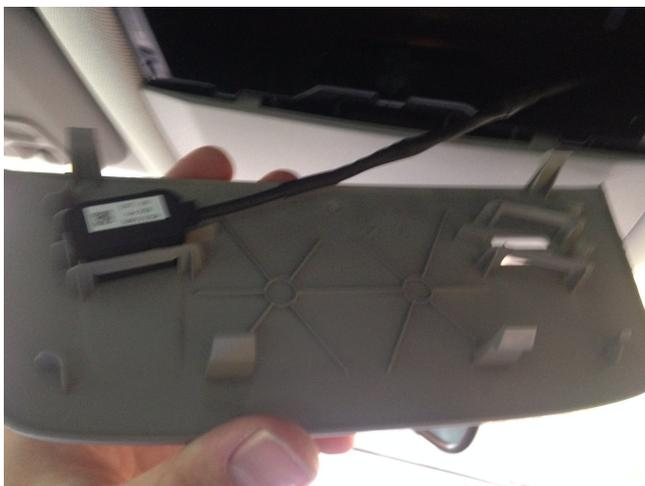
Wenn Sie das Sichtpaket nicht haben und somit nicht die Kappe mit den Schlitz für das Mikro in der Lichteinheit, müssen Sie das Mikro einfach neben dem Innenspiegel positionieren. Dort ist der Empfang am besten.
