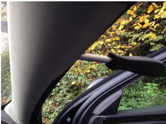
Danach kann das Mikrofonkabel unter dem Dachhimmel bis zur Halteplatte in der Lichteinheit geführt werden (bei vorhandenem Sichtpaket). Das Mikro wird dort einfach eingesteckt.
