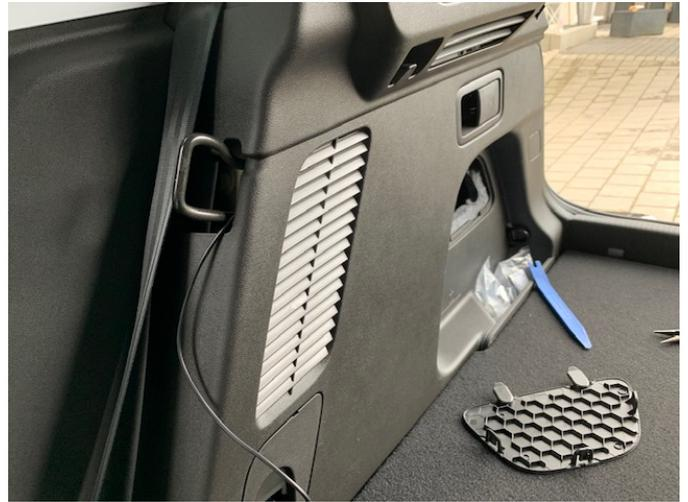
Von dort kann es bis zur Rücksitzbank verlegt werden um es dann auf der Beifahrerseite unter der Schwellerverkleidung bis zum Handschuhfach zu verlegen.
