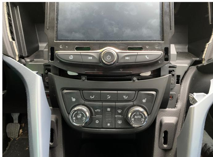
Jetzt können noch die vier Schrauben vom Radio gelöst werden, so dass die komplette Radio/ Display Einheit ausgebaut werden kann.
