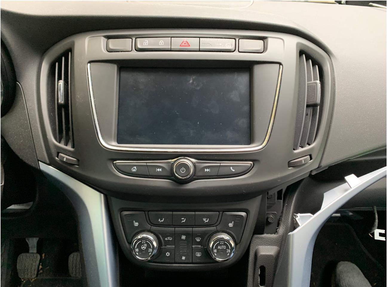
Nun müssen die beiden Schrauben für die Klimasteuerung gelöst werden und das Bedienelement kann ausgebaut werden. Danach kann die große Blende um Das Display/ Radio ausgebaut werden.
