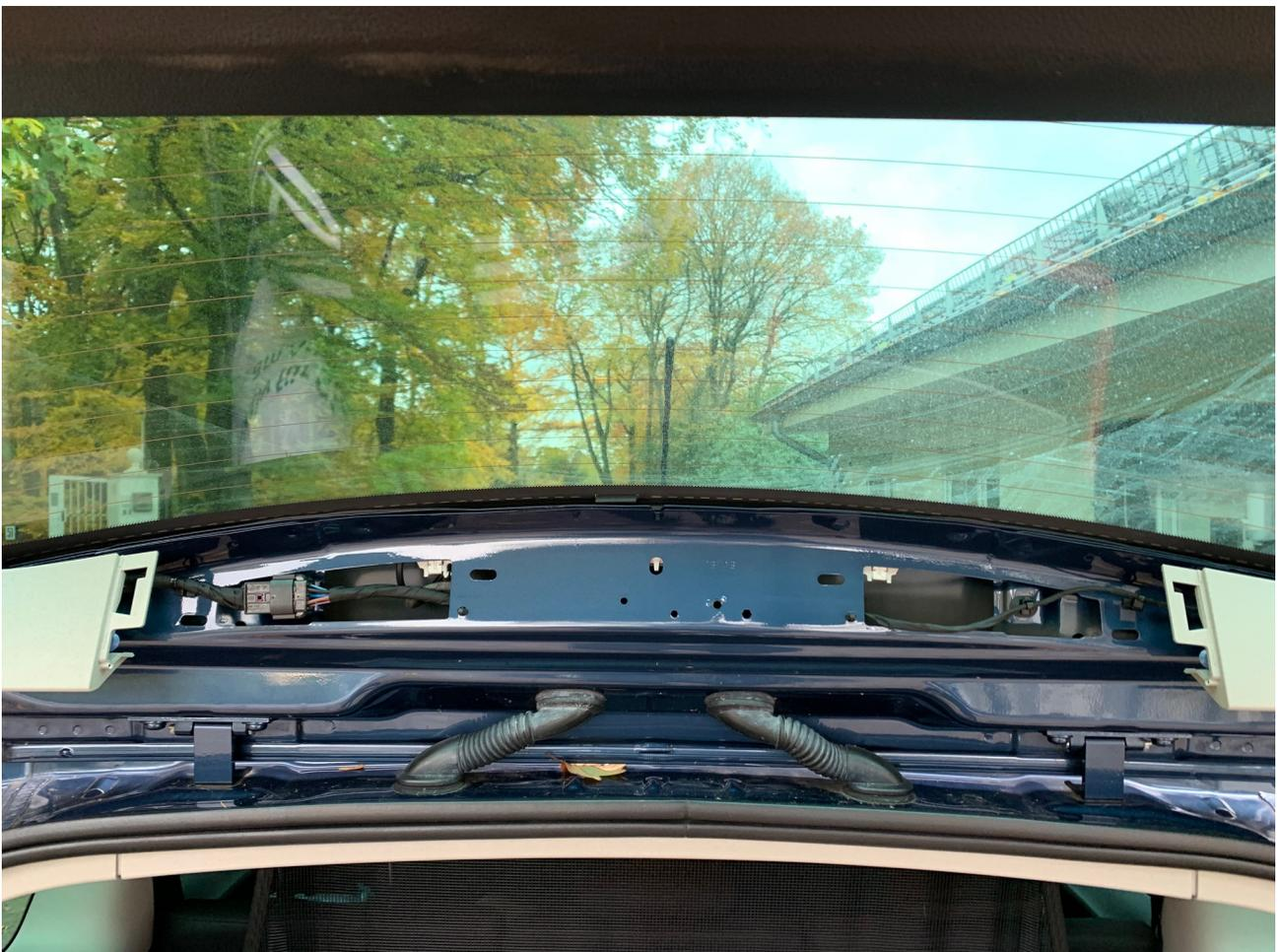
Danach müssen die beiden Schrauben aus dem Griff der Heckklappe gelöst werden.
