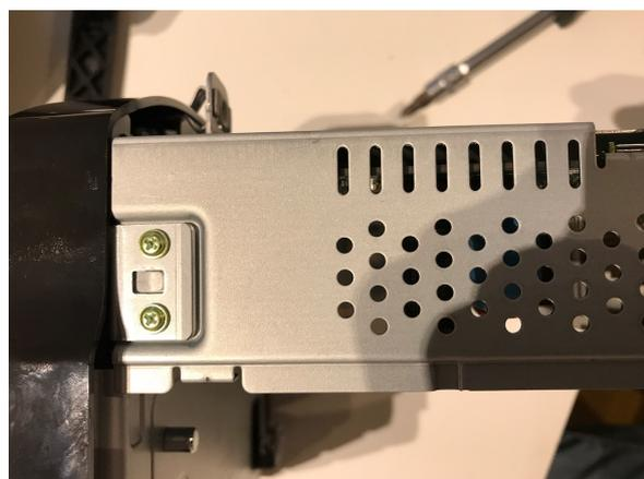
Nun kann die Displayeinheit vom Hauptgerät entfernt werden. Auf der Rückseite muss die Metallabdeckung demontiert und durch die neue Blende aus dem Lieferumfang ersetzt werden.
