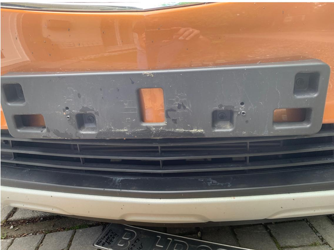
Nun bohren Sie mittig in den Halter ein Loch für die Kamera und verschrauben diese mit dem mitgelieferten Material
