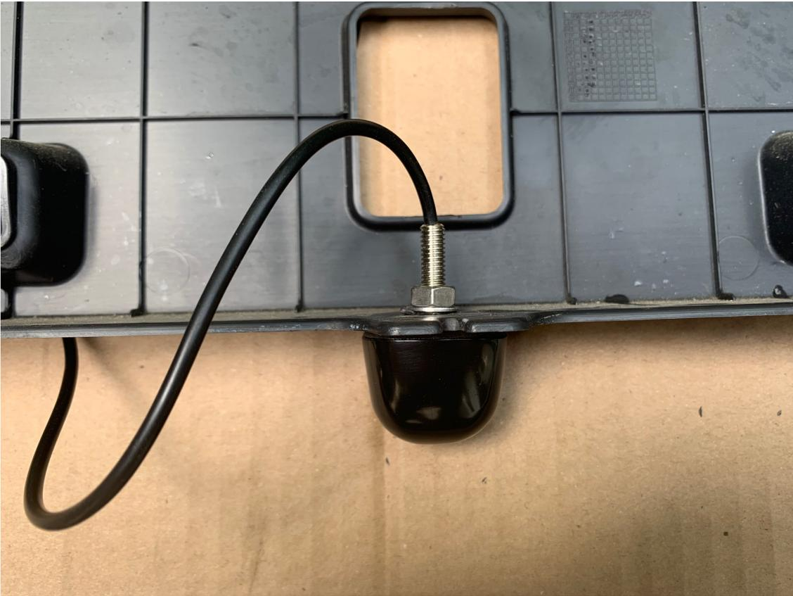
Im folgenden verlegen Sie das mitgelieferte Verlängerungskabel hinter dem Kühlergrill bis unten zur Kamera und schließen dieses an die Kamera an
