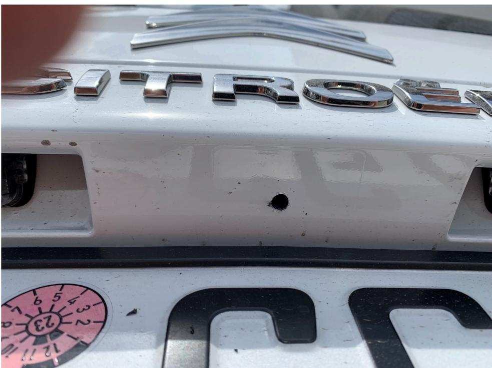
Die Kamera kann dann von hinten verschraubt werden. Das Kabel wird entlang der anderen vorhandene Kabel bis hin zum Kabelkanal verlegt. Die Gummidichtung kann an beiden Enden vom Fahrzeug gelöst werden.
