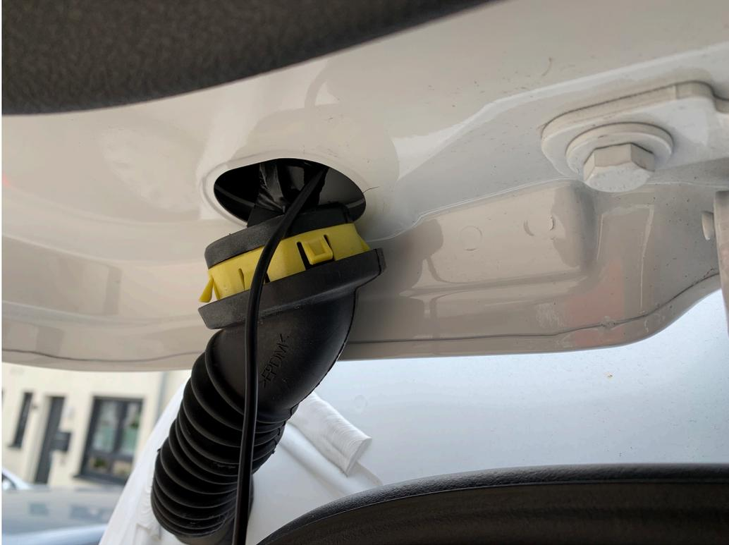
Nun wird das Kabel durch den Kabelkanal verlegt und so in den Innenraum des Fahrzeugs verlegt. Vom Dachhimmel aus kann das Kabel auf der Beifahrerseite nach unten zum Fußraum verlegt werden. Von dort führt der Weg hinten den Verkleidungen der Schwelle bis nach vorne zum Handschuhfach
