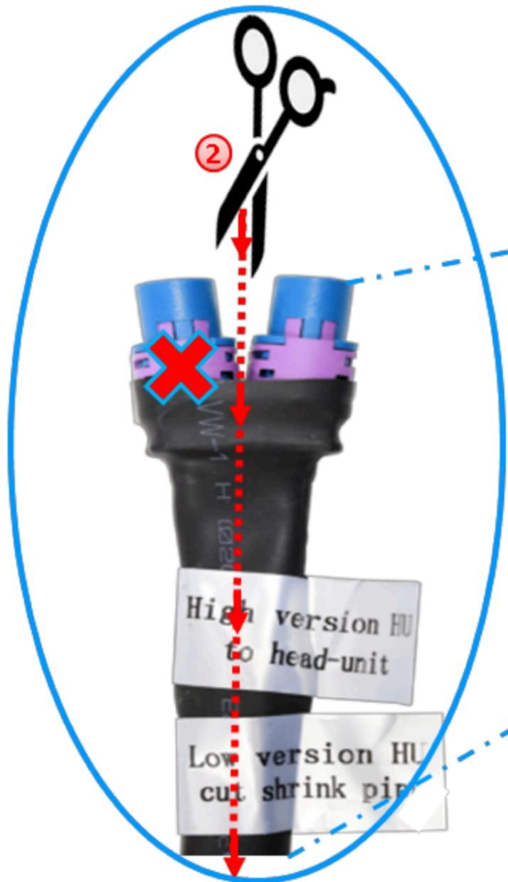
Nun schließen Sie das Kabel mit der Bezeichnung „Low Version HU“ an das Radio an.
