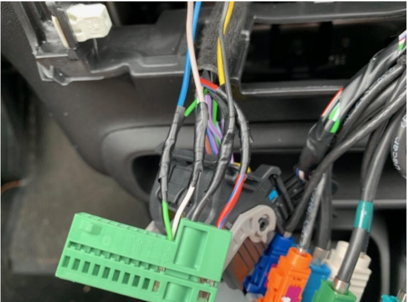
Als nächstes wird die Videoleitung an das Radio angeschlossen. Prüfen Sie zunächst, ob Ihr Radio einen doppelten Stecker oder einen einfachen Stecker hat (schwarzer Anschluss):
