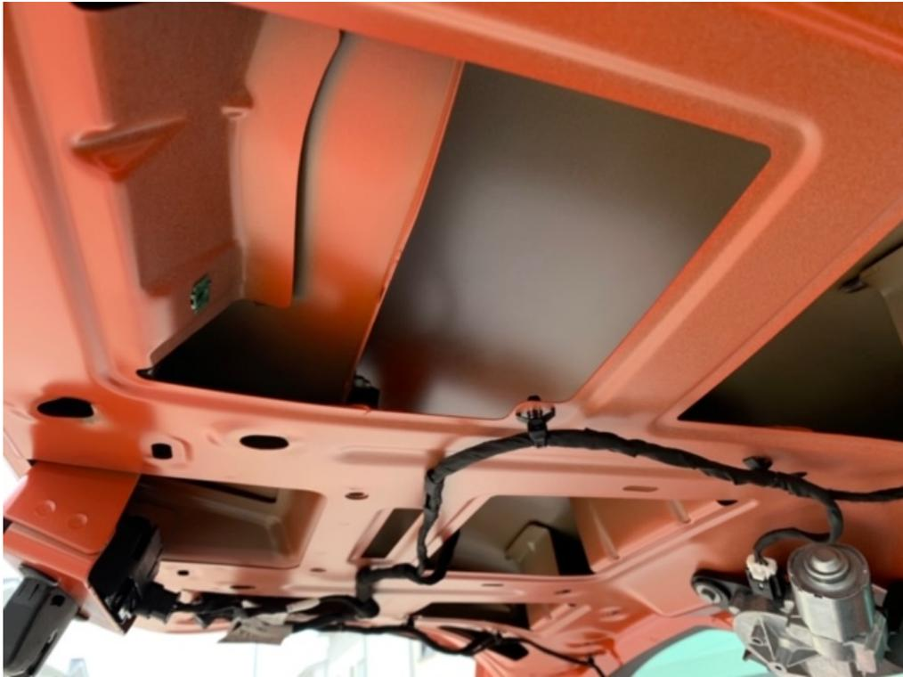
Danach entfernen Sie die Blende für die Kamera. Diese ist nur gesteckt und kann mit einem Keil ausgehebelt werden und bohren ein Loch für die Kamera
