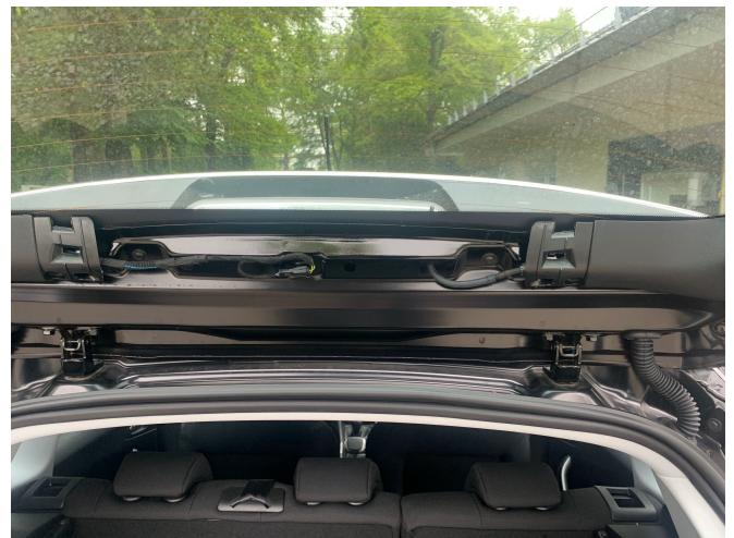
Nun lösen Sie noch die beiden Plastiknieten und können dann die gesamte Verkleidung entfernen
