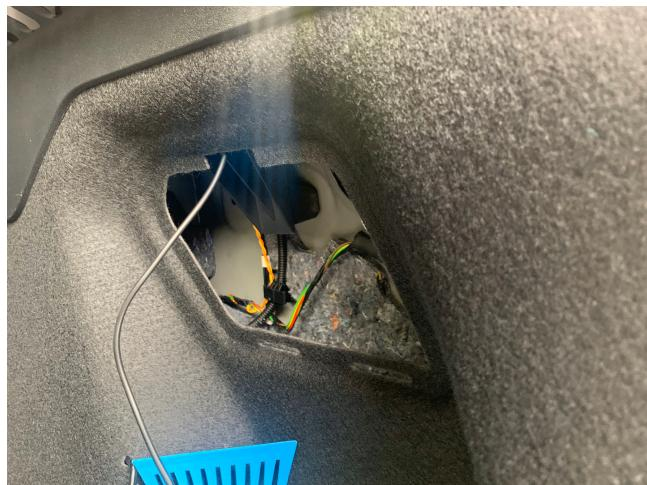
Von dort können Sie das Kabel wie auf den Bildern dargestellt bis nach vorne verlegen und an den entsprechenden Anschluss am Interface anschließen.
