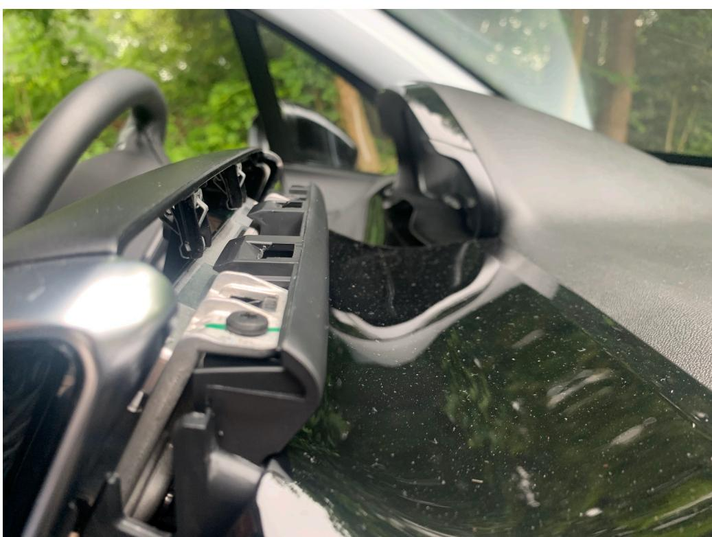
Die nun sichtbar gewordene silberne Box ist das Navi bzw Radio. Lösen Sie die vier Schrauben und ziehen das Navi/ Radio aus dem Schacht.
