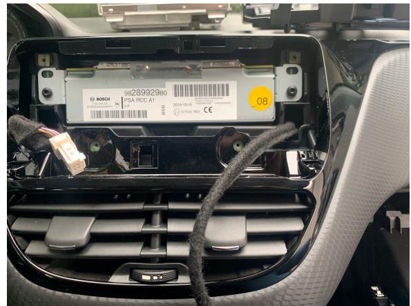
Auf der Rückseite müssen der schwarze große Hauptstecker und der kleine schwarze HSD Stecker für die Videoleitung zum Display entfernt werden.
