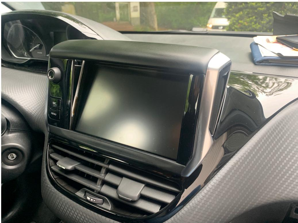
Nun sind zwei Schrauben sichtbar, welche gelöst werden müssen. Danach kann das Display ganz einfach entfernt werden. Lösen Sie dazu noch auf der Rückseite die entsprechenden Stecker.
