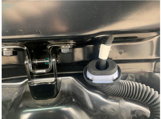
Ziehen Sie das Kabel durch das Gummi in den Innenraum des Fahrzeuges. Lösen Sie auf der rechten Seite die Plastikblende und führen das Kabel von dort runter in den Kofferraum.
