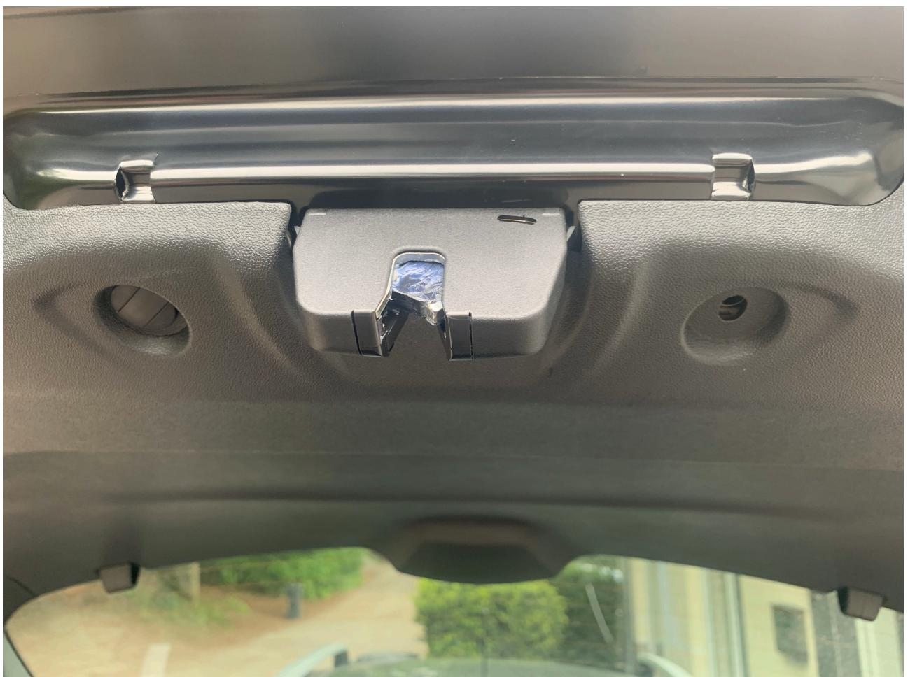
Bohren Sie jetzt das Loch für die Kamera und stecken/ verschrauben diese an der entsprechenden Stelle. Das Kabel kann entlang der anderen Leitungen bis zu der Durchführungen auf der rechten Seite verlegt werden.
