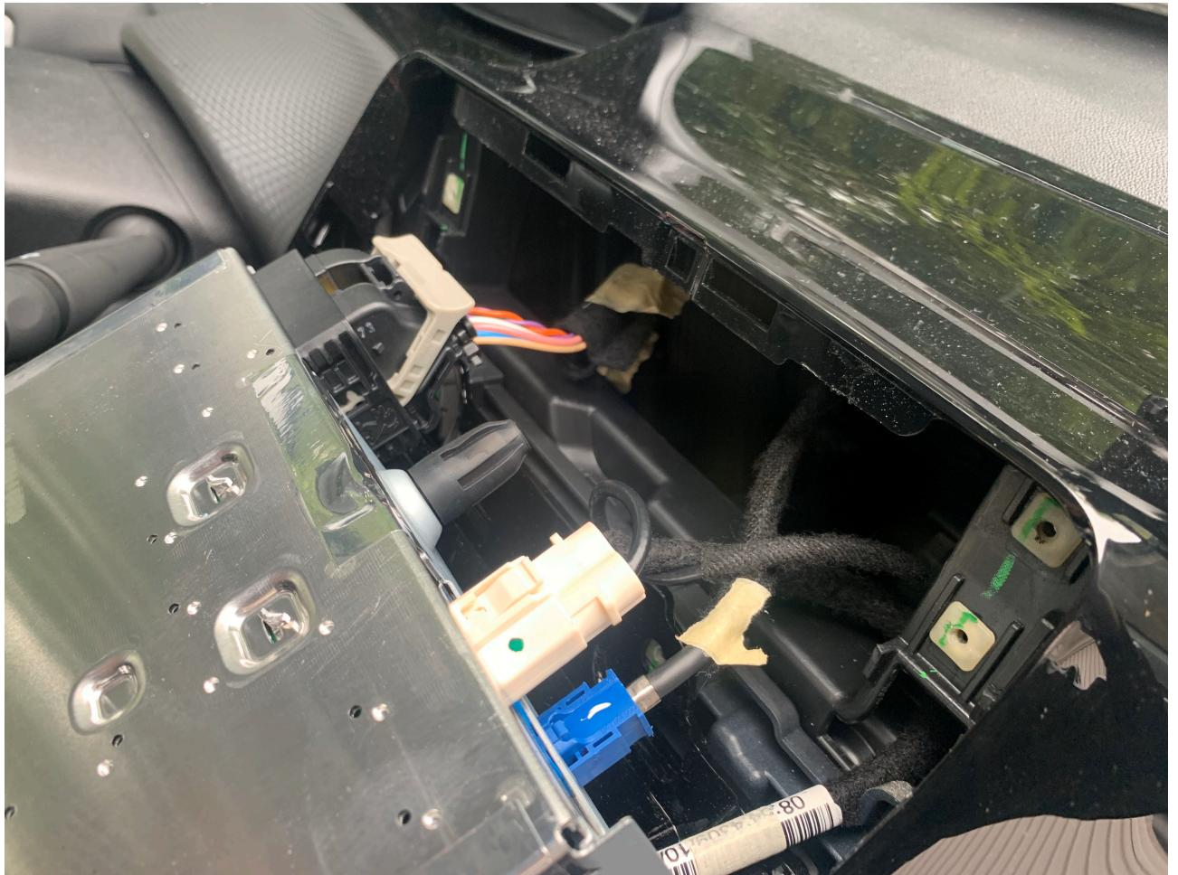
Als erstes muss nun das Kabel wie auf dem folgenden Bild dargestellt aufgetrennt werden.
