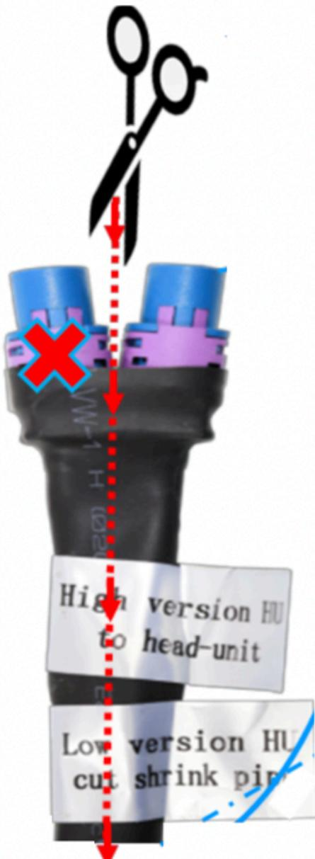
Nun stecken Sie den freigelegten Stecker mit der Bezeichnung **LOW VERSION** in den oben markierten Anschluss am Navi. Den blauen Stecker mit den Kennzeichnung „to Interface“ wird in den passenden blauen Anschluss am Interface gesteckt. Die HSD Buchse, welche vorher im Navi gesteckt hat wird nun in den **LOW VERSION** Eingang am Kabelstrang gesteckt.
