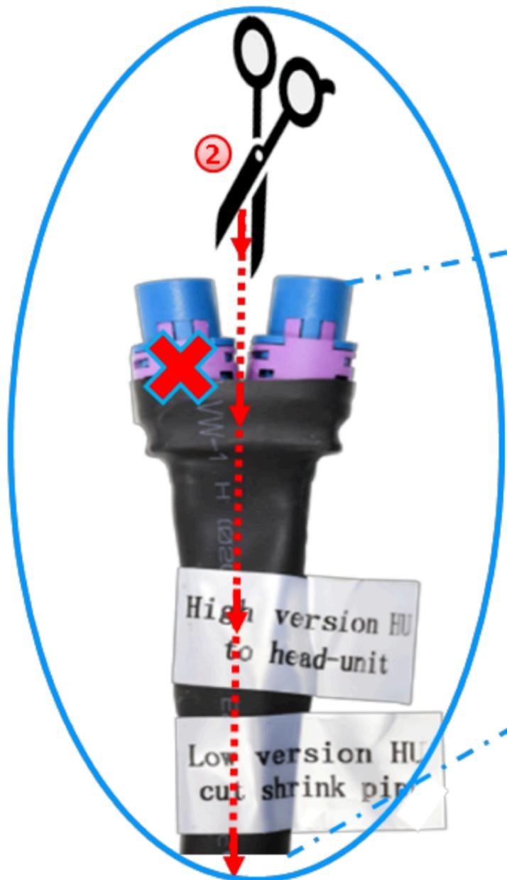
Nun schließen Sie das Kabel mit der Bezeichnung „Low Version HU“ an das Radio an. Das Kabel mit der Bezeichnung „Low Version HU do not Connect“ wird in dem Fall **NICHT** verwendet.
