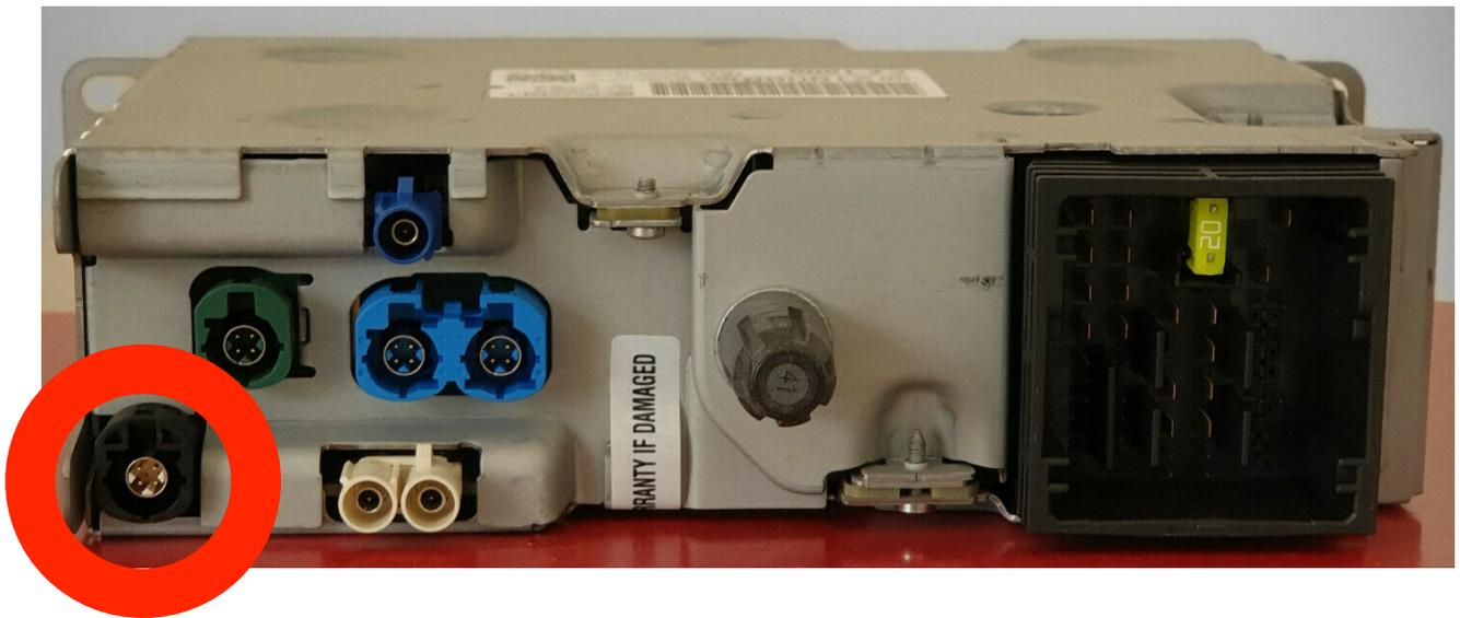
Wenn Ihr Radio einen doppelten Stecker hat, können Sie das im Lieferumfang befindliche Kabel ganz einfach anschließen. Wenn Sie die Version mit nur einem Stecker haben, trennen Sie das beiliegende HSD Kabel bitte an dem doppelten Stecker auf
