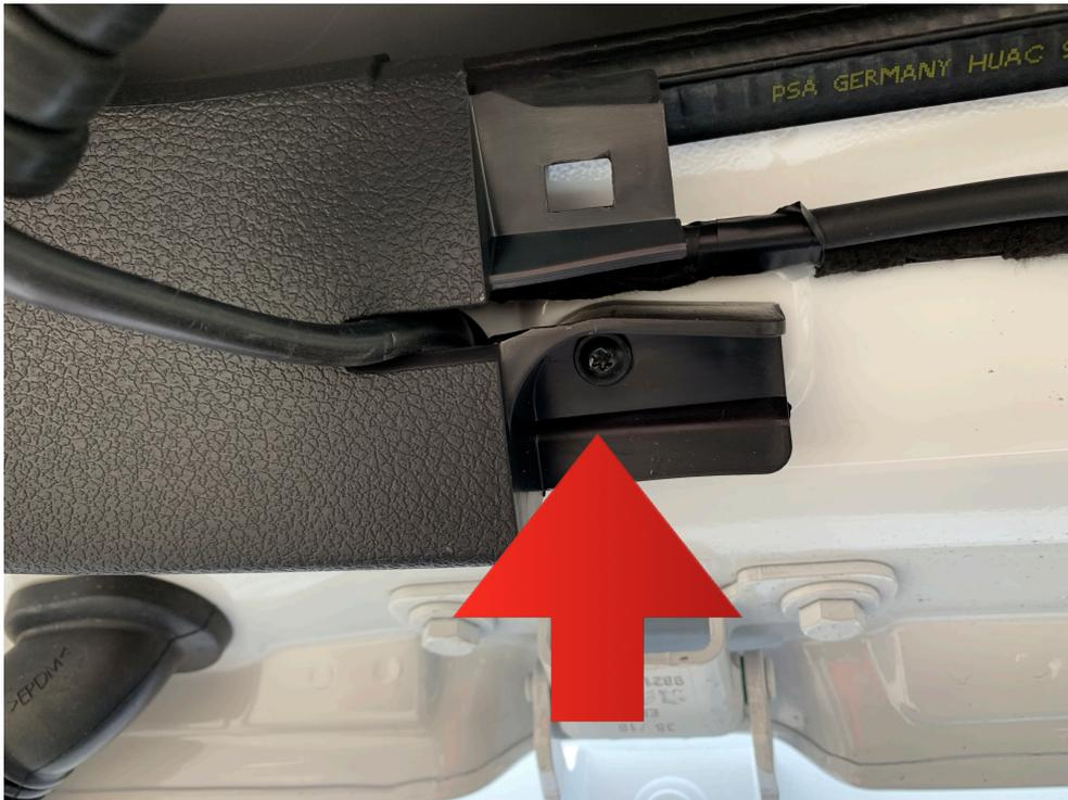
Die beiden Blenden können so ebenfalls entfernt werden. Danach sind noch zwei Schrauben an der großen Verkleidung sichtbar. Diese müssen ebenfalls entfernt und dann die gesamte Heckverkleidung gelöst werden
