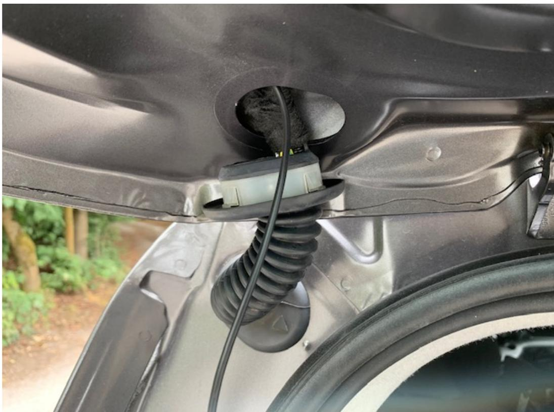
Führen Sie das Kabel durch die Dichtung nach innen und dann auf der Beifahrerseite im Kofferraum nach unten. Von dort kann es unter den Schwellerverkleidungen nach vorne zum Navi verlegt und angeschlossen werden.
