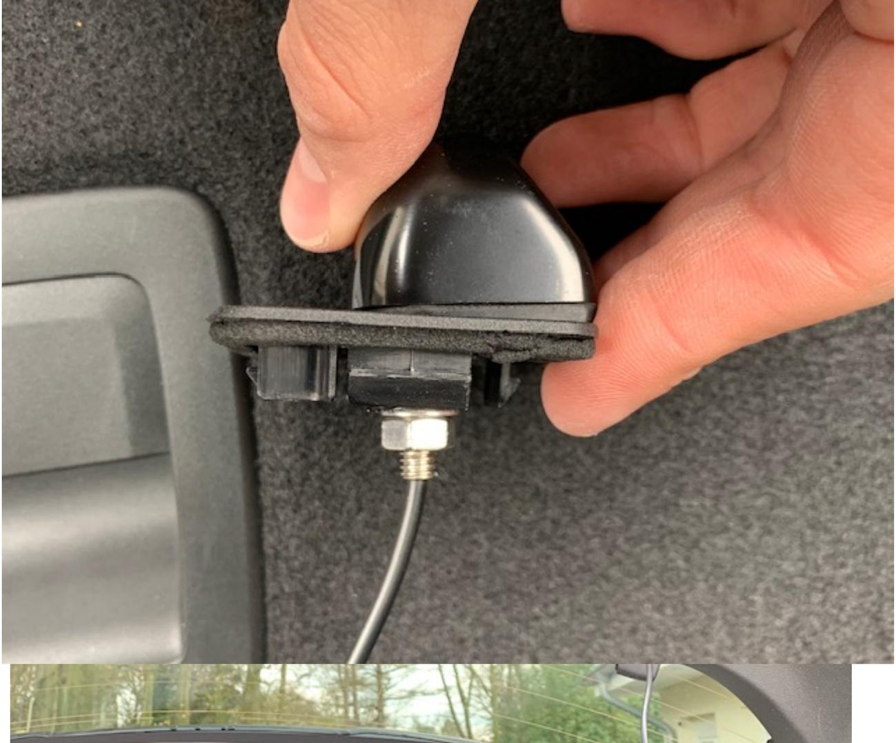
Als nächstes wird die Blende für die Kamera aus der Heckklappe entfernt und das Loch für die Kamera gebohrt
