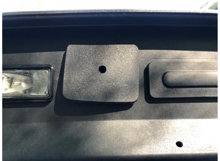
Die Kamera kann mit der beiliegenden Unterlegscheibe und der Mutter befestigt werden. Bei Bedarf kann mit Hilfe des Keils der Winkel der Kamera noch nach unten verändert werden.
