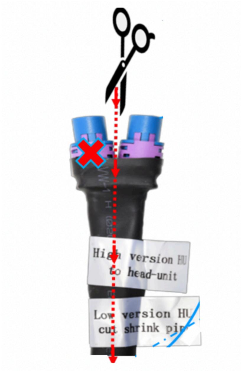
Nun stecken Sie den freigelegten Stecker mit der Bezeichnung **LOW VERSION** in den oben markierten Anschluss am Navi. Den blauen Stecker mit den Kennzeichnung „to Interface“ wird in den passenden blauen Anschluss am Interface gesteckt. Die HSD Buchse, welche vorher im Navi gesteckt hat wird nun in den **LOW VERSION** Eingang am Kabelstrang gesteckt.
