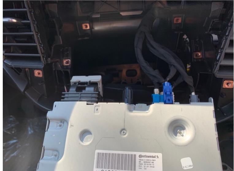
Auf der Rückseite müssen der schwarze große Hauptstecker und der kleine schwarze HSD Stecker für die Videoleitung (siehe Bild) entfernt werden.
