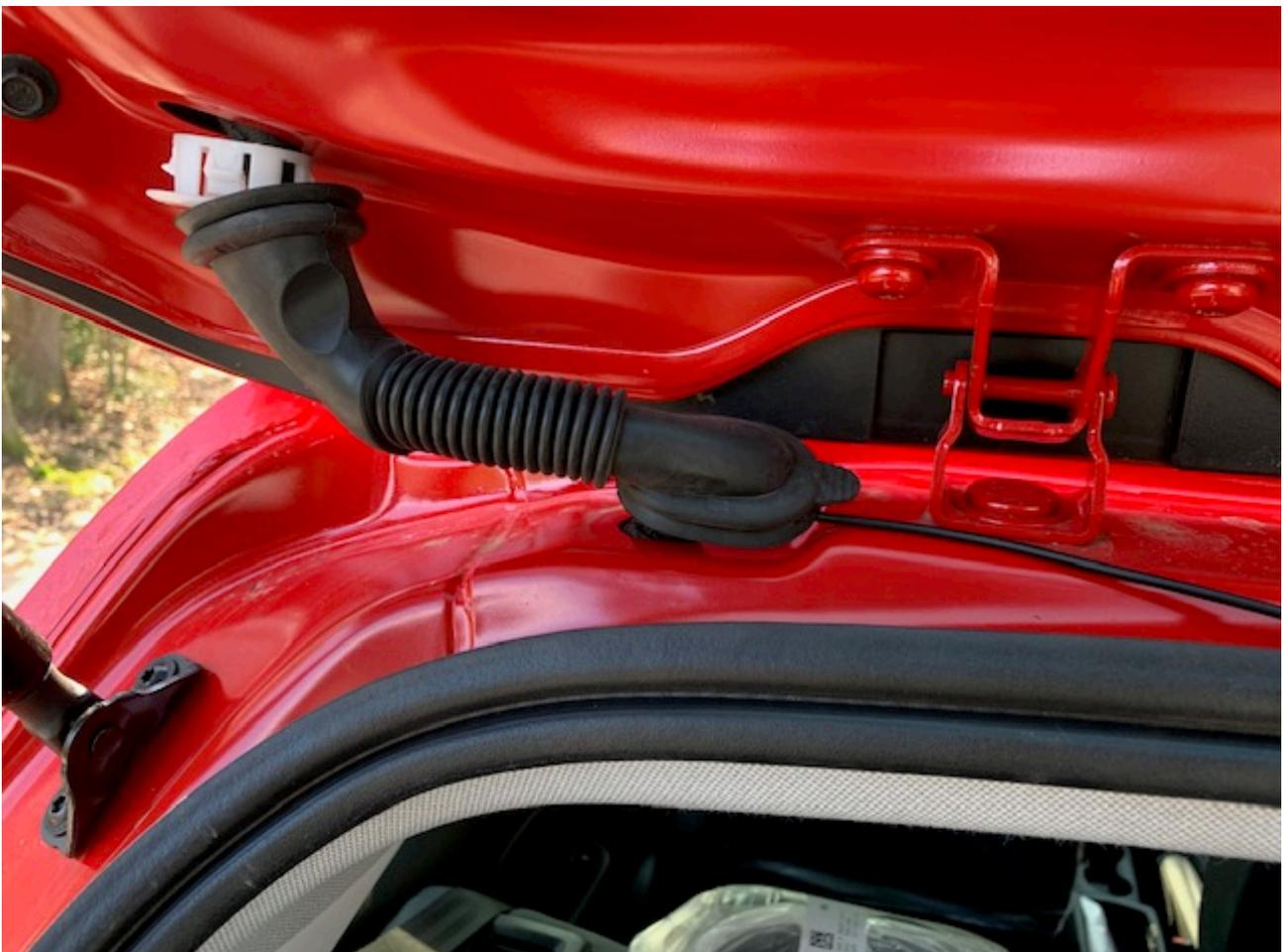
Unter dem Dachhimmel kann das Kabel auf die Beifahrerseite im Kofferraum verlegt worden. Von dort führt der Weg bis zur Rückbank. Nun kann das Kabel ganz einfach entlang der Schwellerverkleidungen bis zum Handschuhfach gezogen werden.
