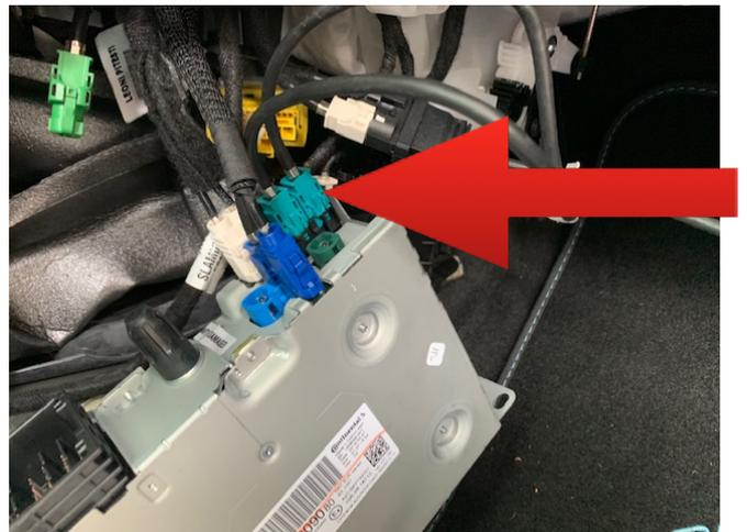
Aus dem Hauptstecker muss der kleine grüne Innenstecker entriegelt werden. Dort werden nun die Kabel des Interface wie folgt angeschlossen:
