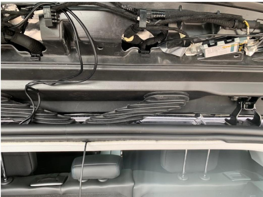
Lösen Sie nun die Blende rechts am Dachhimmel etwas, so dass das Kabel hinter der Verkleidung nach unten verlegt werden kann. Zusätzlich muss die kleine Blende rechts unten im Kofferraum geöffnet werden um das Kabel dort wieder herausziehen zu können.
