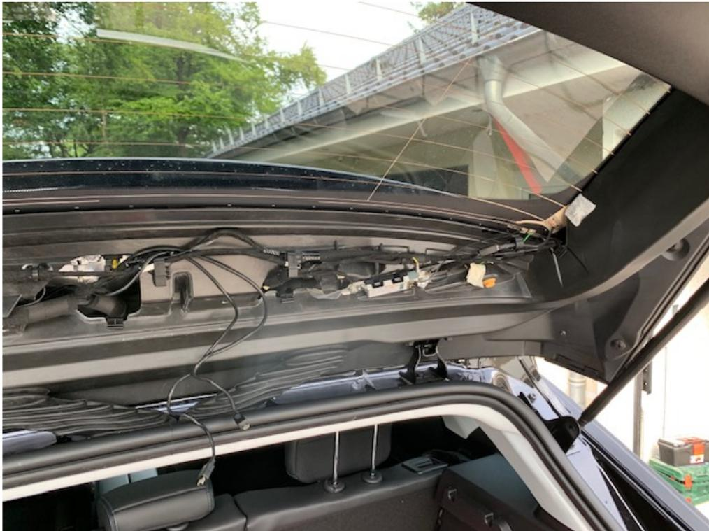
Nun können die beiden Blenden in der Heckklappe noch entfernt werden. Diese sind auch nur gesteckt und können ganz einfach herausgenommen werden
