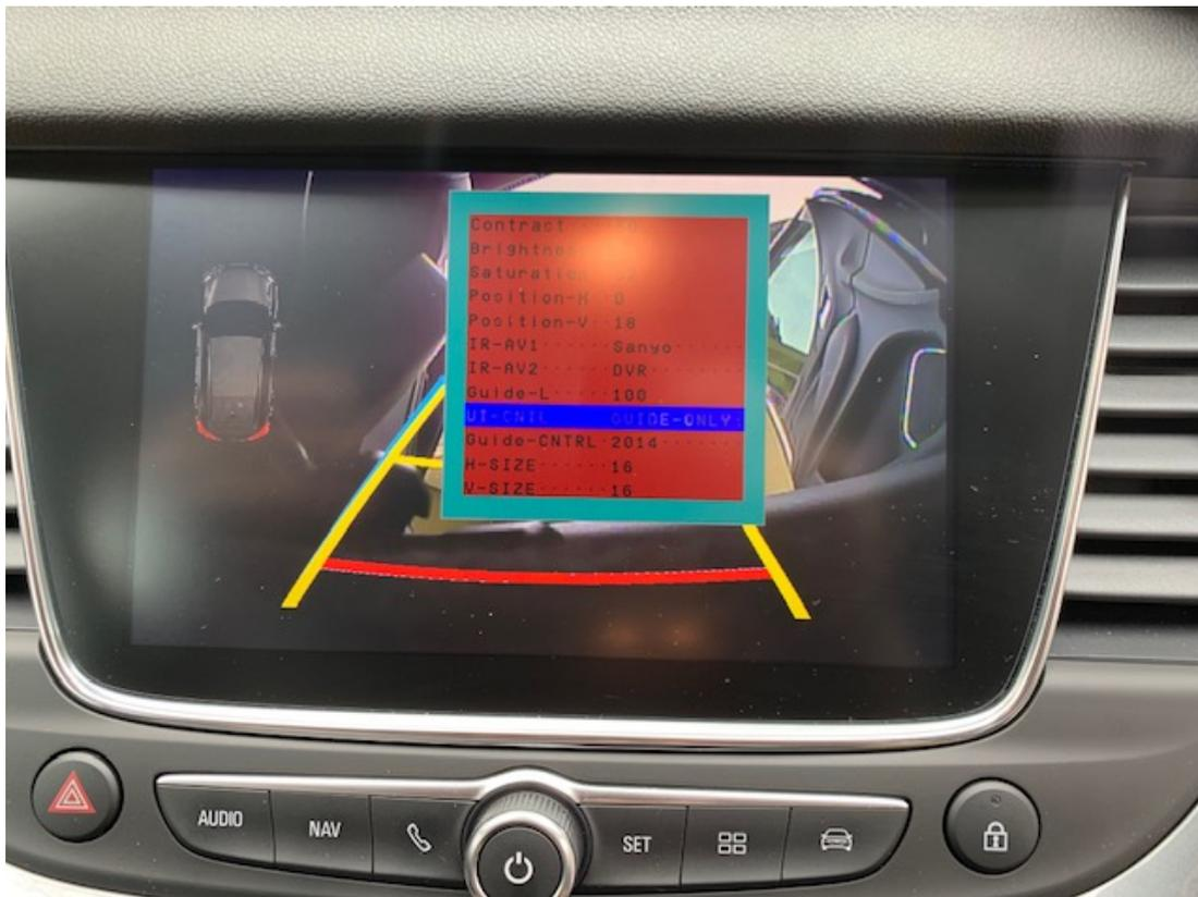
Sofern das Bild der Rückfahrkamera nicht mittig ist oder ein kleines Auto rechts am Bildschirmrand zu sehen ist können Sie dies im Menü des Interface anpassen. Dazu drücken Sie die Menü Taste am Interface. Mit den folgenden Werten können Sie die Einstellungen anpassen:
