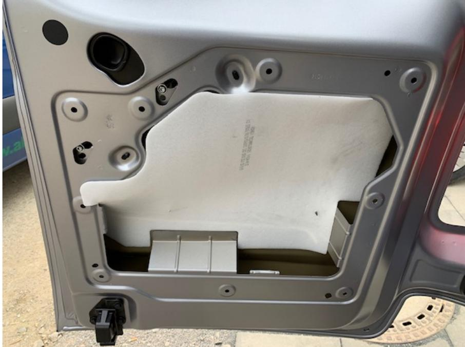
Nun muss das Loch für die Kamera / Kamerakabel gebohrt werden und das Kabel nach innen geführt werden.
