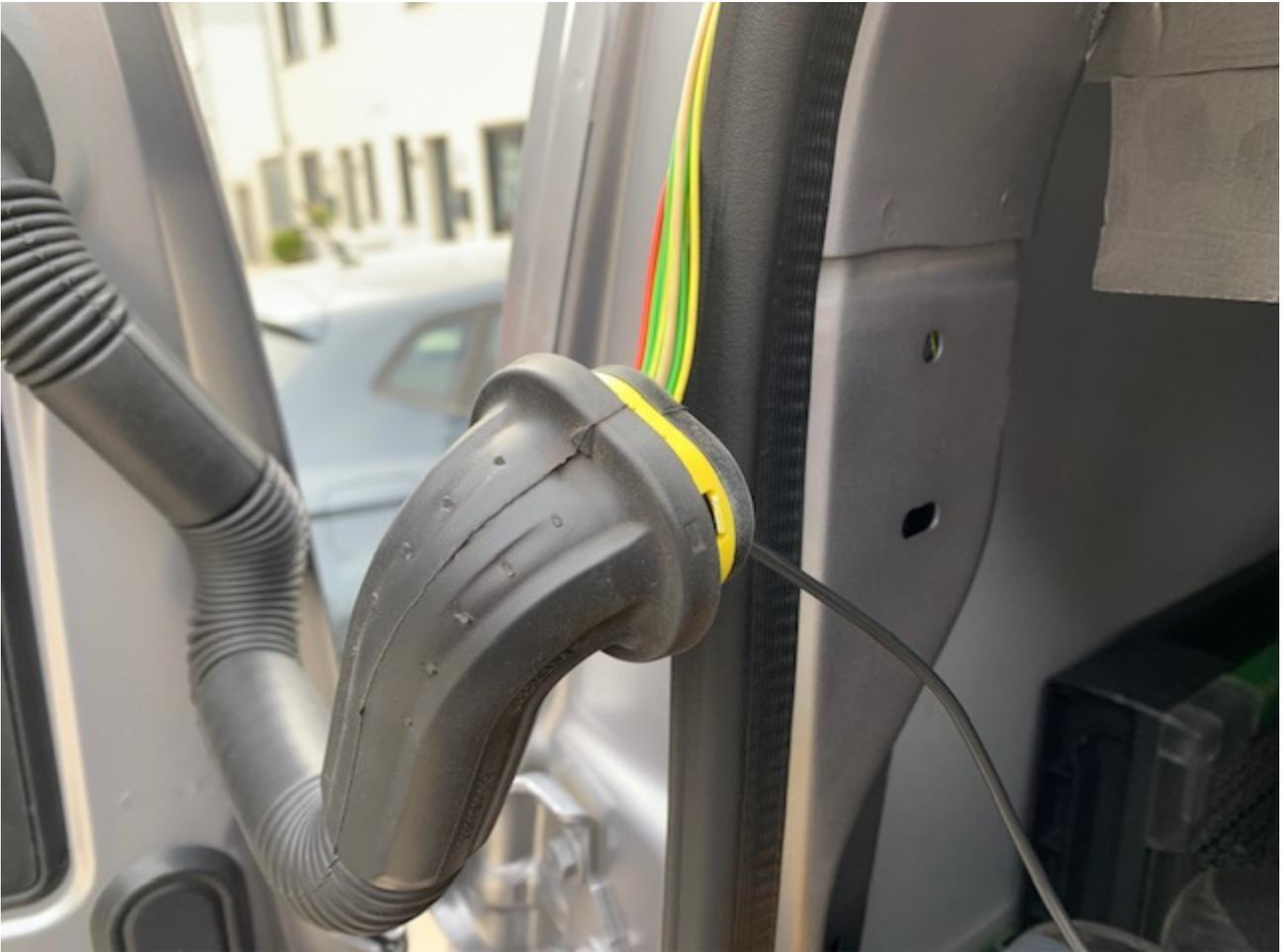
Am Dachhimmel verläuft ein Kabelkanal. Dort kann das Kabel für die Rückfahrkamera ebenfalls reingelegt werden
