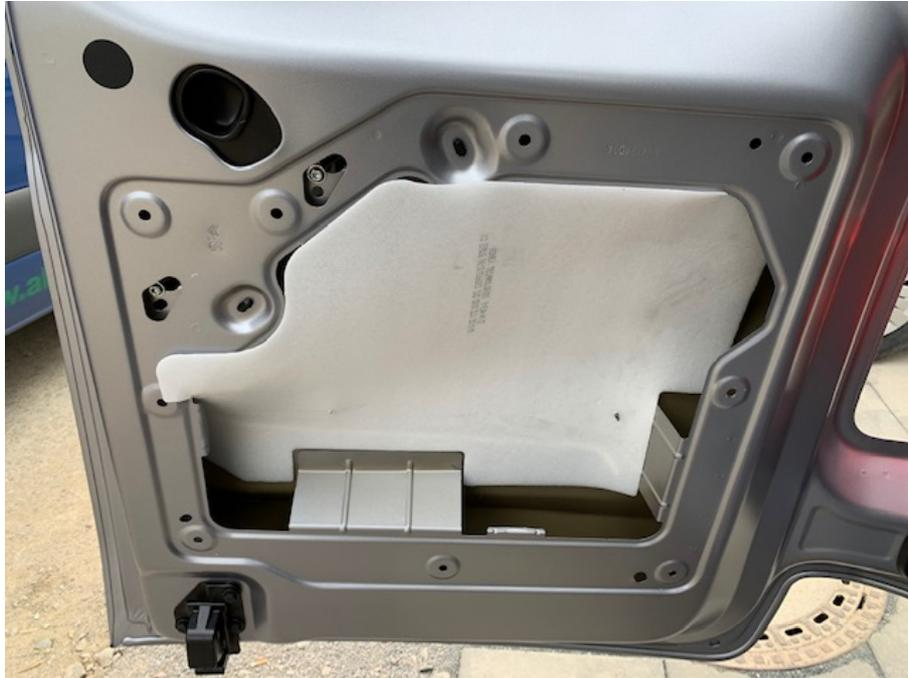
Als erstes muss die Verkleidung der Kofferraumklappe entfernt werden. Dazu lösen Sie die Nieten wie auf dem Bild dargestellt
