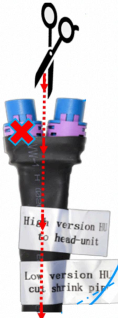
Nun stecken Sie den freigelegten Stecker mit der Bezeichnung **LOW VERSION** in den oben markierten einzelnen schwarzen Anschluss am Navi. Den blauen Stecker mit den Kennzeichnung „to Interface“ wird in den passenden blauen Anschluss am Interface gesteckt. Die HSD Buchse, welche vorher im Navi gesteckt hat wird nun in den **LOW VERSION** Eingang am Kabelstrang gesteckt.
