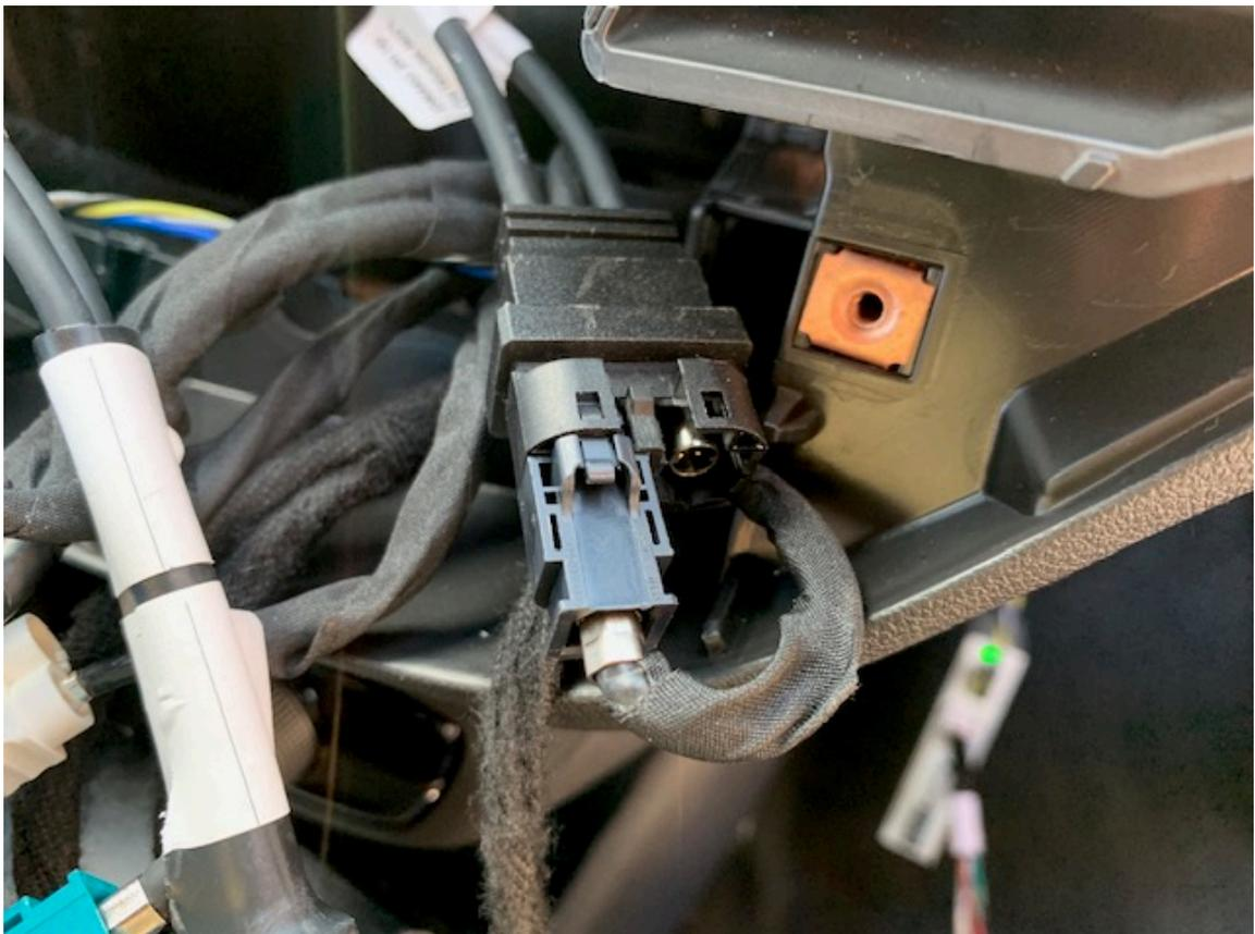
Ziehen Sie nun den Hauptstecker aus dem Radio und lösen die innenliegende grüne Steckerleiste. Dort werden nun die Kabel des Interface wie folgt angeschlossen (Kabelfarben können variieren, bitte verlassen Sie sich auf die Pinbelegung):
