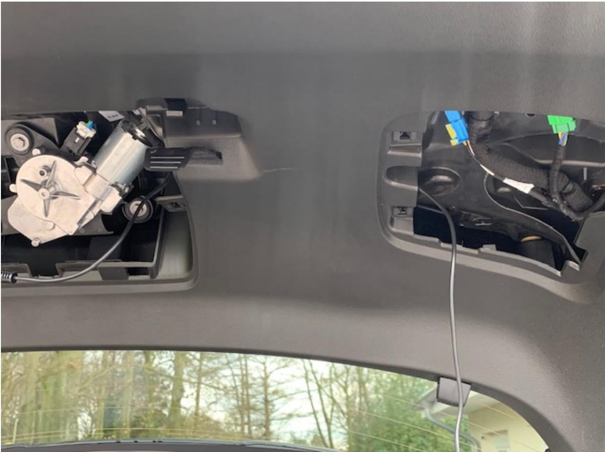
Als nächstes wird die Blende für die Kamera aus der Heckklappe entfernt und das Loch für
