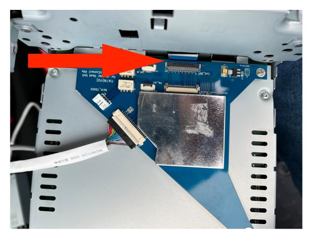
Danach kann unsere Adapterplatte wieder mit den Torx Schrauben am Radio befestigt werden.
