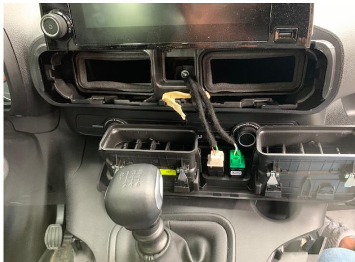
Nun lösen Sie auch die Schrauben, die die Bedieneinheit für die Klimaanlage halten. Entfernen Sie im folgenden das Display und lösen die Kabel auf der Rückseite.
