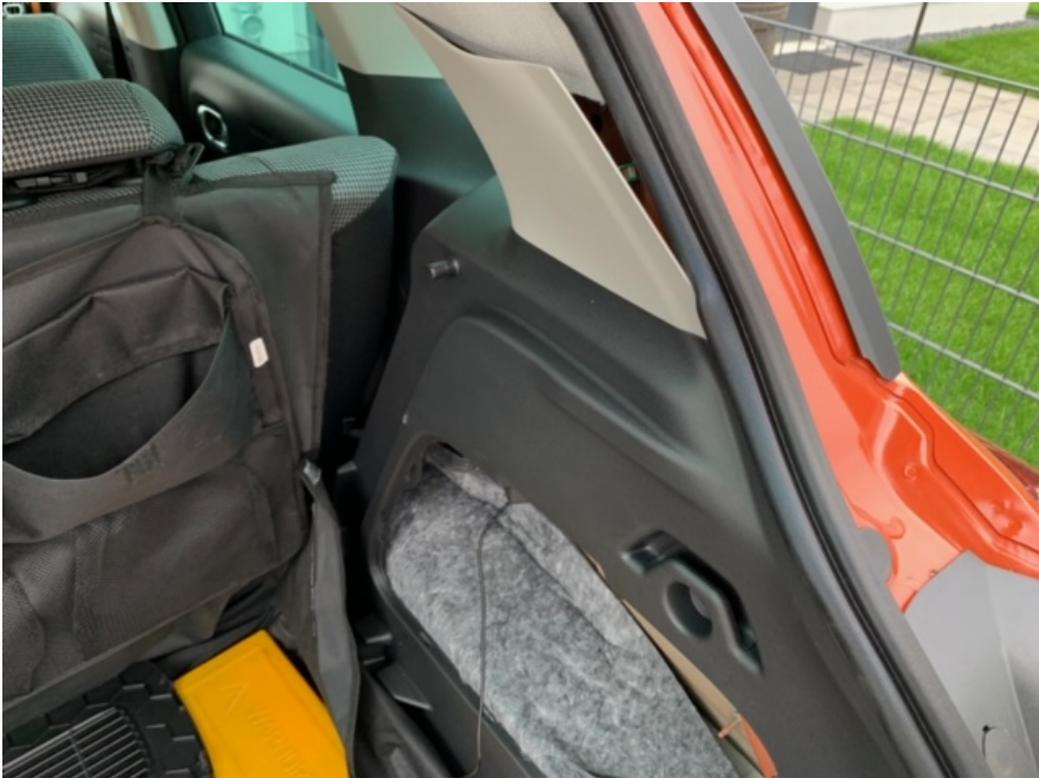
Nun können Sie das Kabel bis in der Kofferraum und von dort zur Rückbank ziehen
