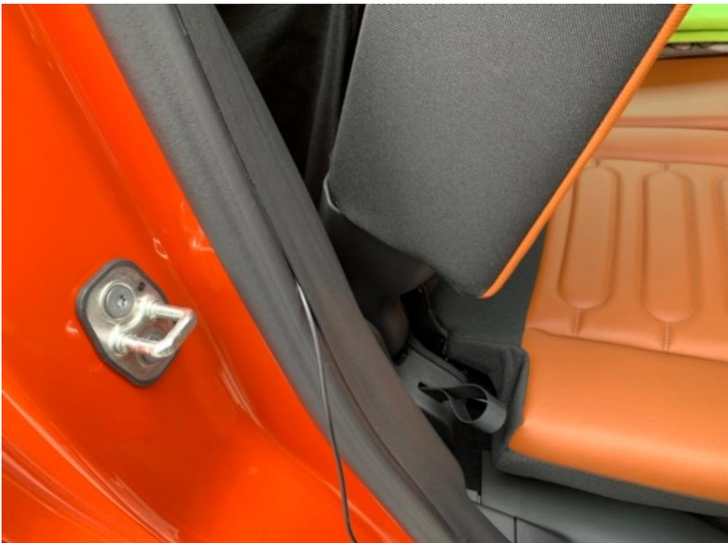
Von dort können Sie das Kabel unter der Verkleidung der Schwelle bis nach vorne zum Interface ziehen und dort anschließen
