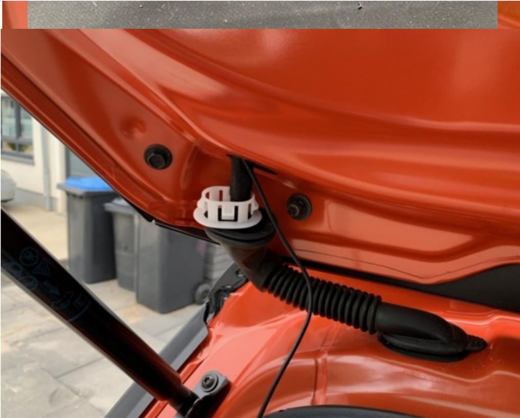
Verschrauben Sie die Kamera mit der Blende und stecken diese wieder in die entsprechende Aussparung. Das Kabel verlegen Sie nun zur Kabeldurchführung an der Heckklappe
