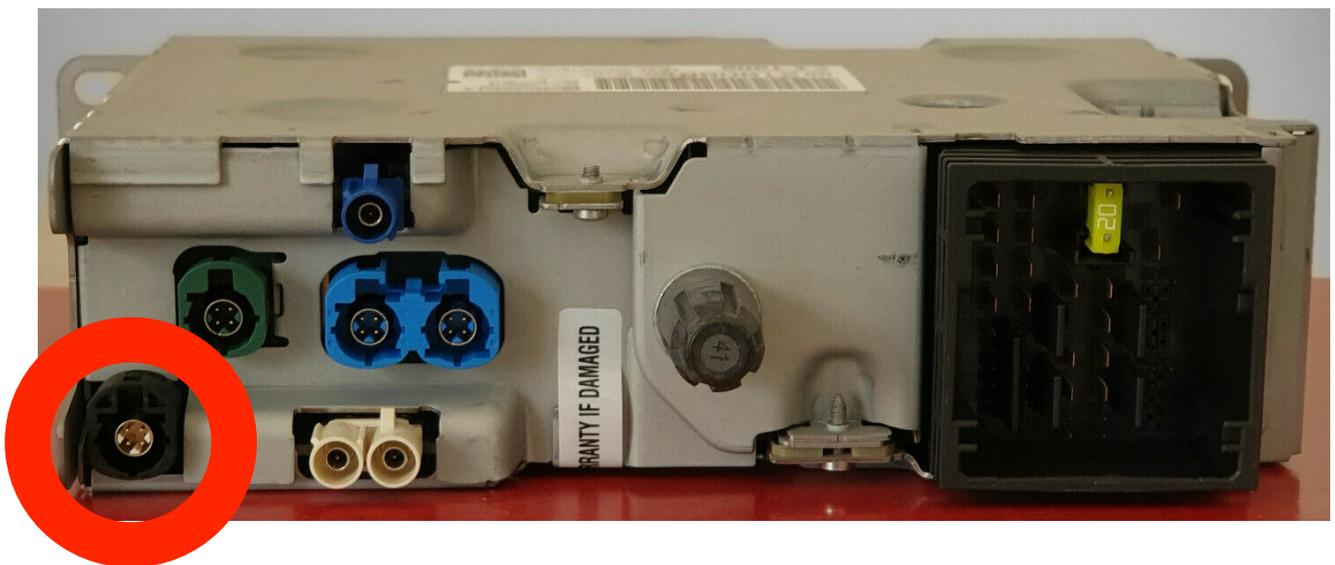
Lösen Sie jetzt die innenliegende grüne Steckerleiste des großen Hauptsteckers. Dort werden nun die Kabel des Interface wie folgt angeschlossen:
