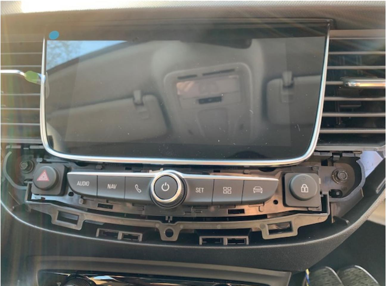
Nun sind zwei Schrauben sichtbar, welche gelöst werden müssen. Danach kann das Display ganz einfach entfernt werden. Lösen Sie dazu noch auf der Rückseite die entsprechenden Stecker. Die nun sichtbar gewordene silberne Box ist die Navieinheit. Lösen Sie die beiden Schrauben und ziehen das Navi aus dem Schacht.
