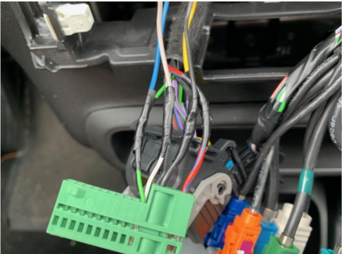
Als nächstes wird die Videoleitung an das Radio angeschlossen. Auf der Rückseite des Navi/ Radio finden Sie einen einzelnen **schwarzen Stecker** (siehe Markierung, die Position des schwarzen Steckers kann je nach Radio/ Navi variieren). Ziehen Sie das Kabel aus dem Stecker heraus und stecken dieses in unseren Adapter. Der gelieferte Adapter wird dann in das Radio/ Navi gesteckt.
