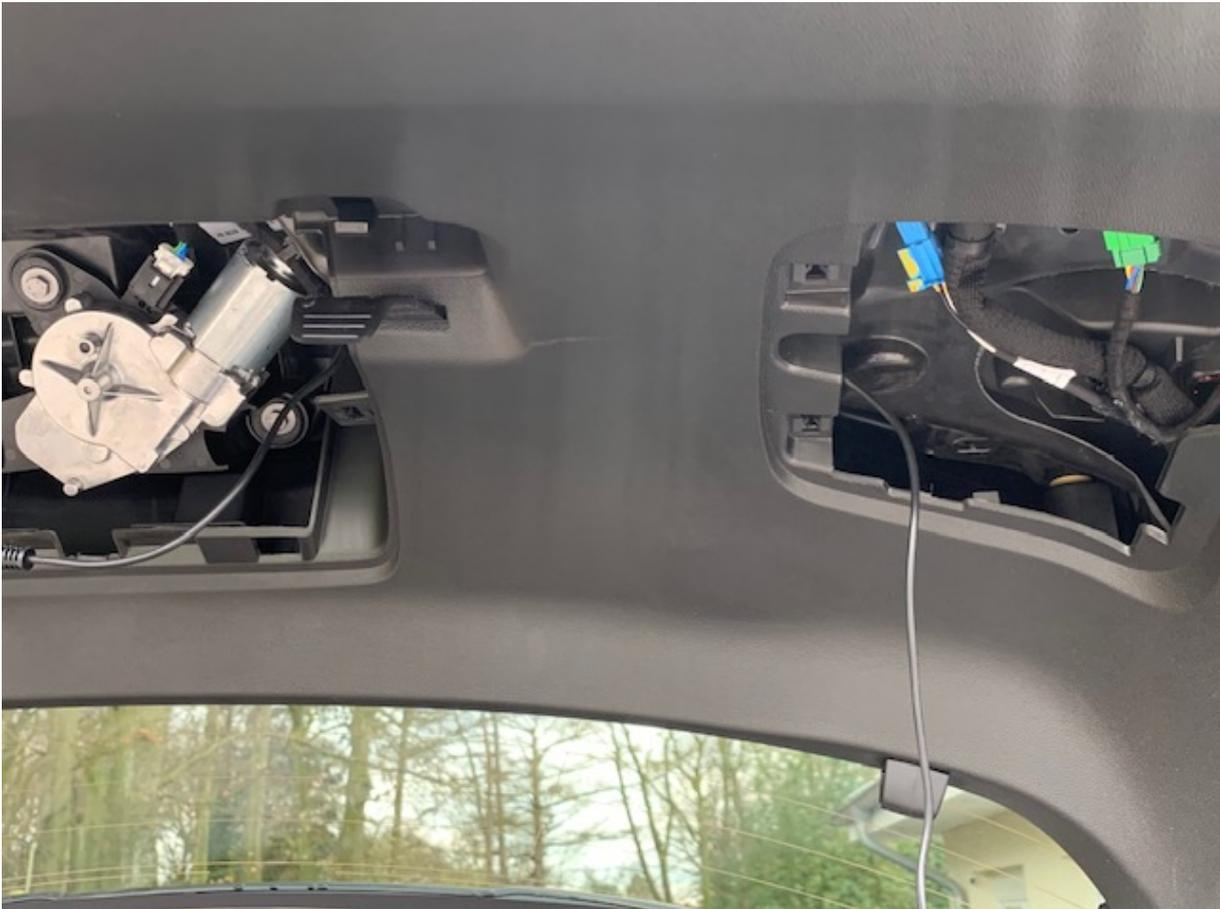
Als nächstes wird die Blende für die Kamera aus der Heckklappe entfernt und das Loch für die Kamera gebohrt
