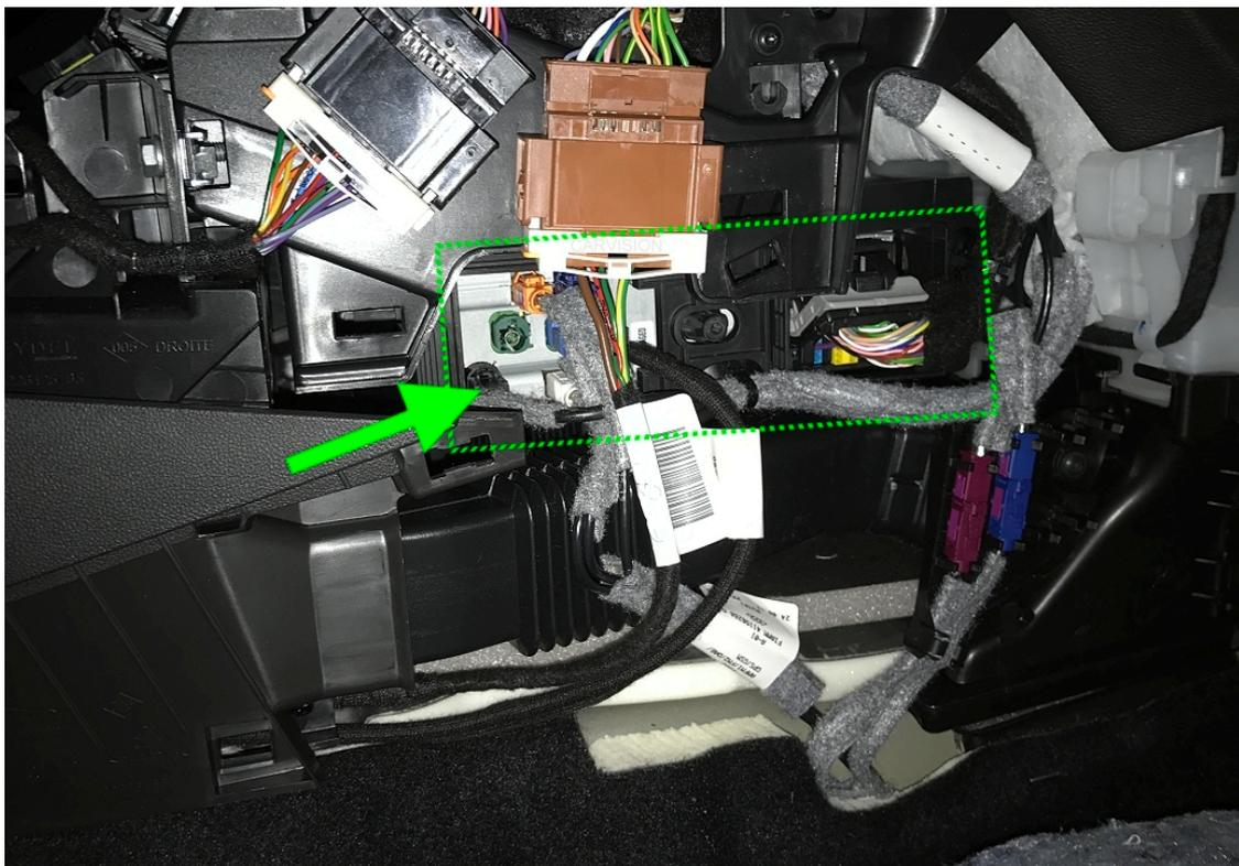
Als nächstes wird die Videoleitung an das Radio angeschlossen. Auf der Rückseite des Navi/ Radio finden Sie einen einzelnen **schwarzen Stecker** (siehe Markierung, die Position des schwarzen Steckers kann je nach Radio/ Navi variieren). Ziehen Sie das Kabel aus dem Stecker heraus und stecken dieses in unseren Adapter. Der gelieferte Adapter wird dann in das Radio/ Navi gesteckt.
