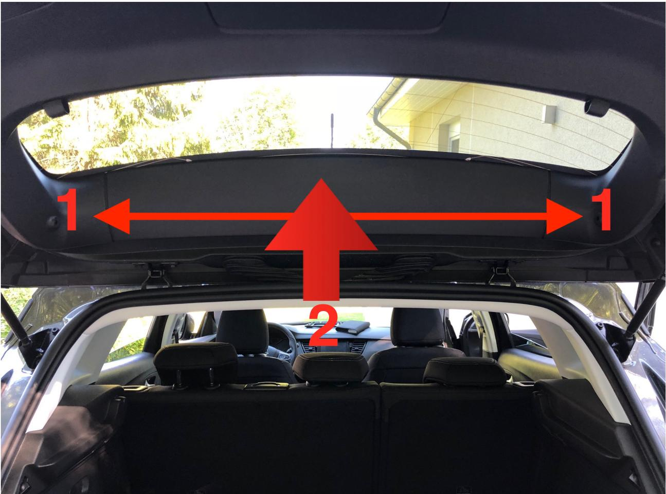
Die große Blende (2) ist nur gesteckt und kann einfach ausgehebelt werden. Danach müssen die beiden Schrauben die hinter der Verkleidung sind auch gelöst werden um die seitlichen Elemente entfernen zu können.
