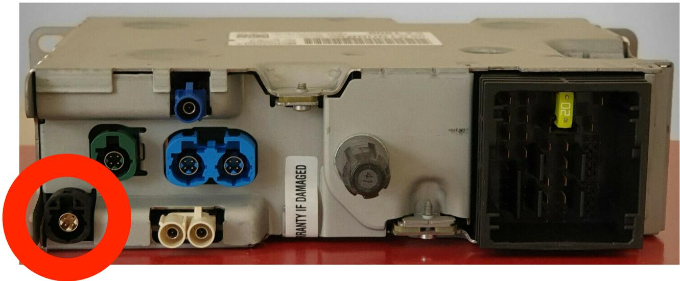
Lösen Sie den grünen Stecker im Hauptanschluss des Radio.
