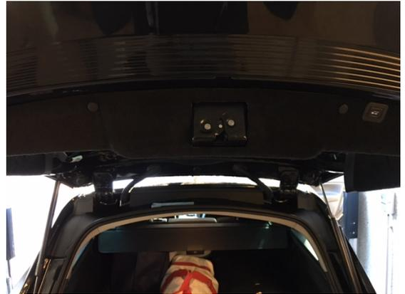
Im folgenden muss die Außenblende der Heckklappe entfernt werden. Dazu müssen von innen die 8 Muttern sowie die beiden Schrauben rechts und Links außen gelöst werden.
