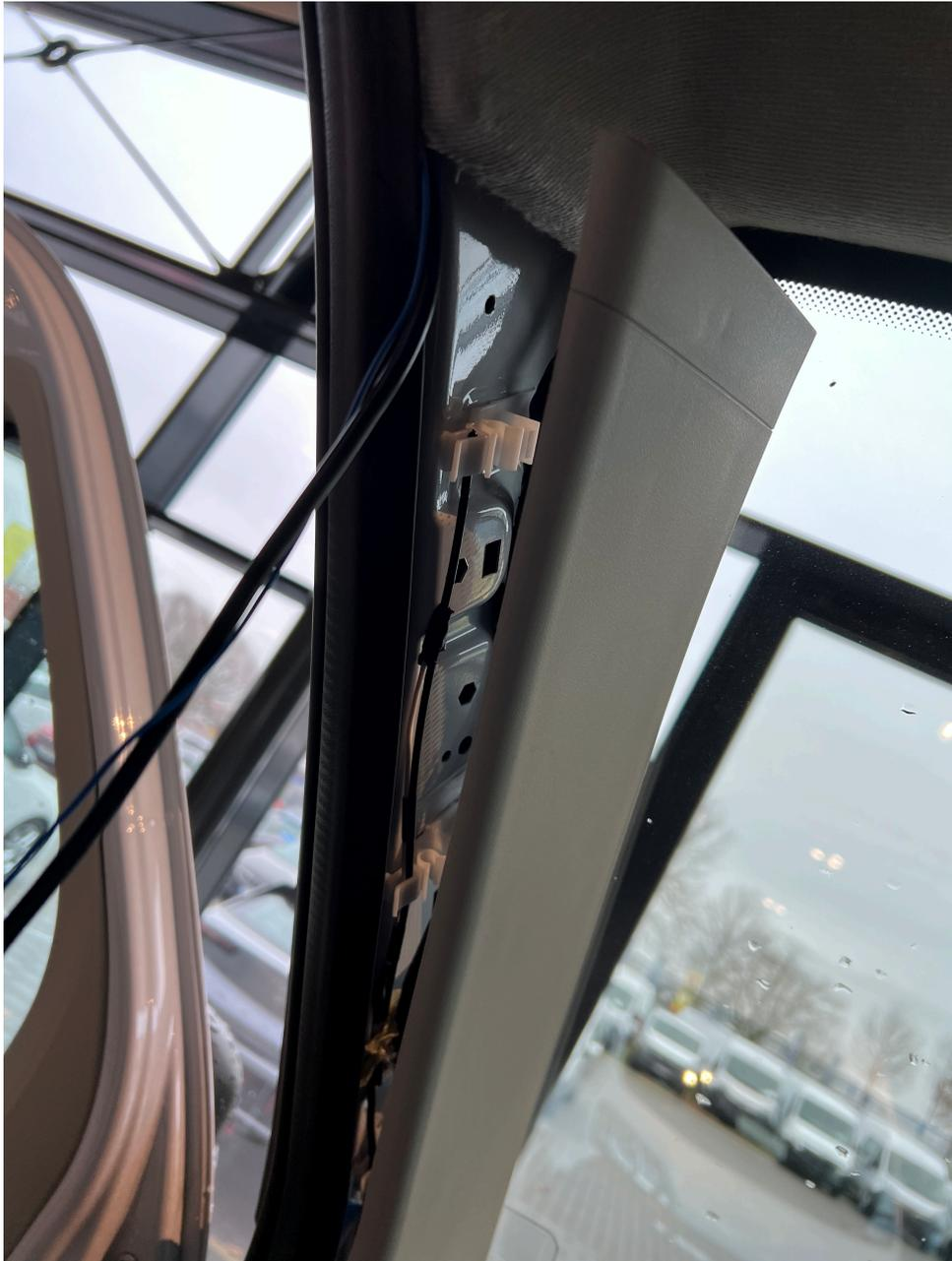
Danach wird noch der Videostecker der Rückfahrkamera in den Videoeingang an dem Adapter gesteckt.
