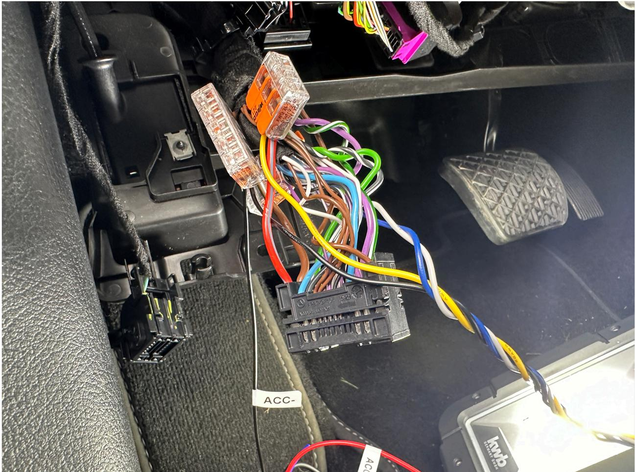
Nun müssen Sie noch das rote Kabel der Kamera mit dem grünen Kabel am Interface mit der Bezeichnung „Cam Power 12V“ verbinden. Die grüne Leitung mit der Bezeichnung Trig-Reserve bleibt unbenutzt.
