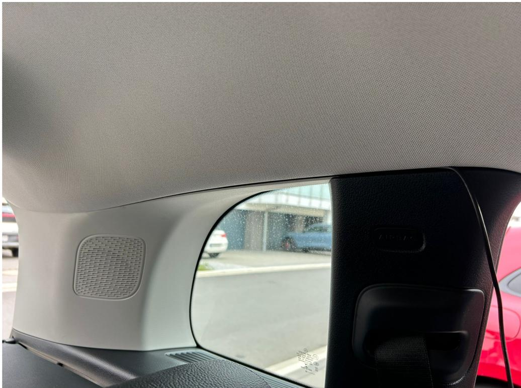
Achten Sie bitte beim Verlegen immer auf den Airbag unter dem Dachhimmel, so dass Sie diesen nicht beschädigen.
