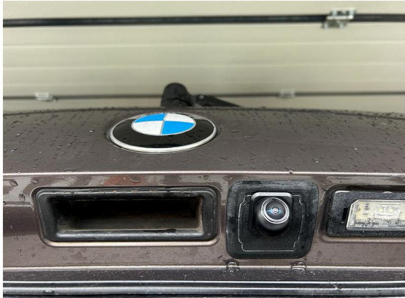
Nun muss das Kabel der Kamera bis vorne zum Steuergerät verlegt werden. Dazu führen Sie dieses zunächst durch die Gummidichtung der Heckklappe.
