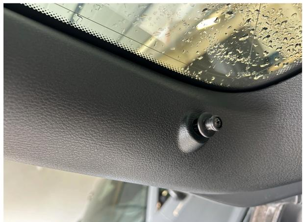
Bohren Sie nun das Loch für die Kamera in der vorgesehene Blende oder einer anderen geeigneten Position. In Einzelfällen erhalten Sie eine Kamera welche im Griff oder der Kennzeichenbeleuchtung verbaut wird. In diesem Fall müssen Sie kein Loch bohren.
