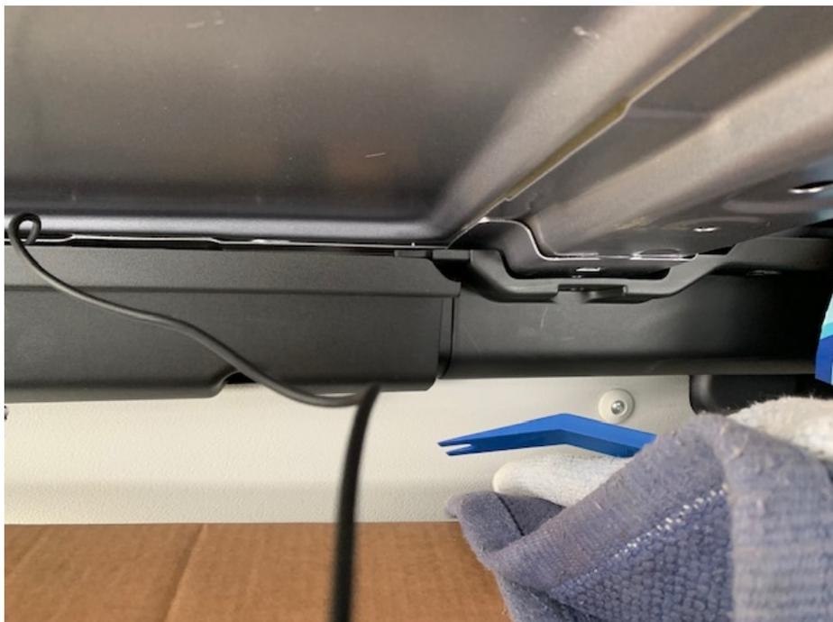
Vorne angekommen, können Sie das Kabel entlang der A-Säule nach unten Richtung Radio verlegen um es dort an das Interface anzuschließen
