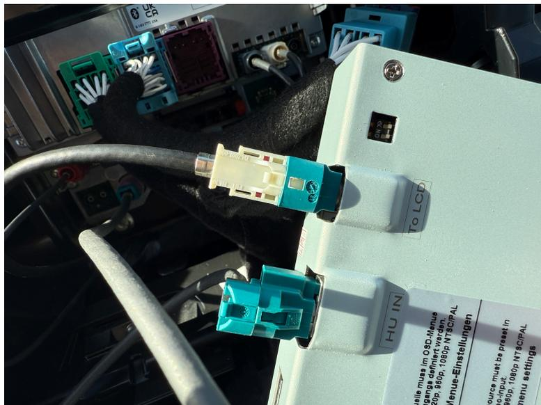
Das rote Kabel der Rückfahrkamera wird am Steuergerät an die grüne Leitung Cam Power angeschlossen und das schwarze Kabel der Rückfahrkamera wird an Masse angeschlossen. Der Videostecker der Rückfahrkamera wird an den entsprechenden Videoeingang (Real V4) am Interface eingesteckt.
