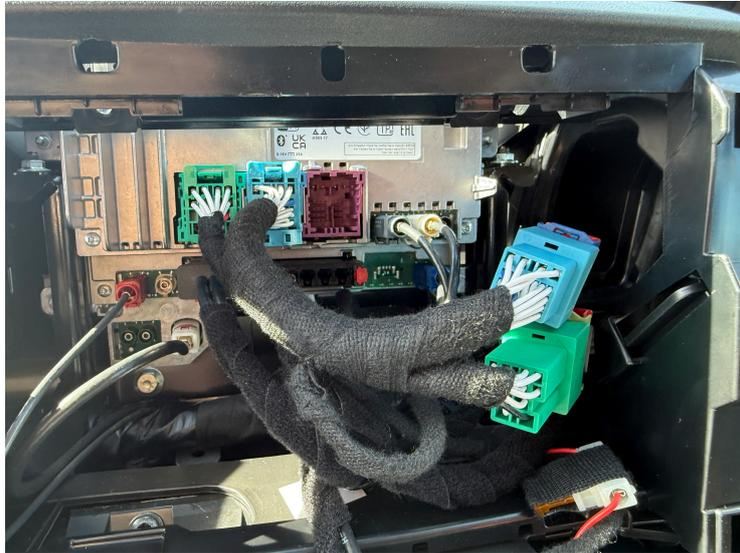
Lösen Sie nun den weißen HSD Stecker links unten am Radio. Dieses Kabel stecken Sie am gelieferten Steuergerät an den Eingang To LCD. Das mitgelieferte schwarze Kabel mit dem HSD Stecker wird am Steuergerät in den Eingang HU IN gesteckt und dann am Radio an dem freien Steckplatz wo vorher das weiße Kabel steckte.
