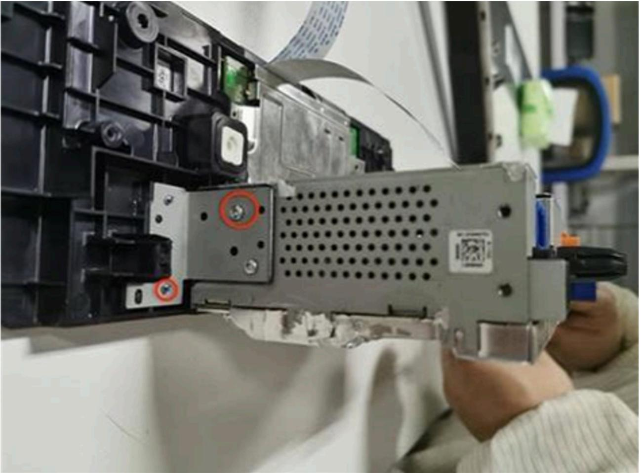
Als nächstes wird die Metallabdeckung vom Display entfernt und die 50 Pin Flexleitung am Mainboard ausgeklipst.
