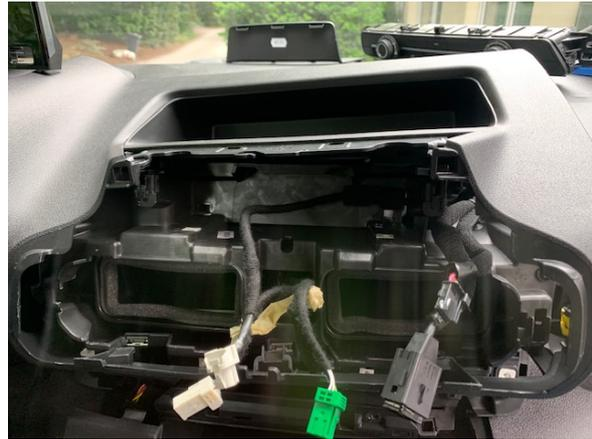
Als nächstes muss noch die große Blende die um den Tacho verbaut ist entfernt werden. Dazu nehmen Sie links im Fahrzeug den Getränkehalter raus und lösen die Lüftungsdüse links vom Lenkrad. Dort finden Sie jeweils eine Schraube. Zusätzlich sind hinter der Blende vom Tacho noch drei Schrauben verbaut. Im folgenden können Sie die große Blende herausnehmen.
