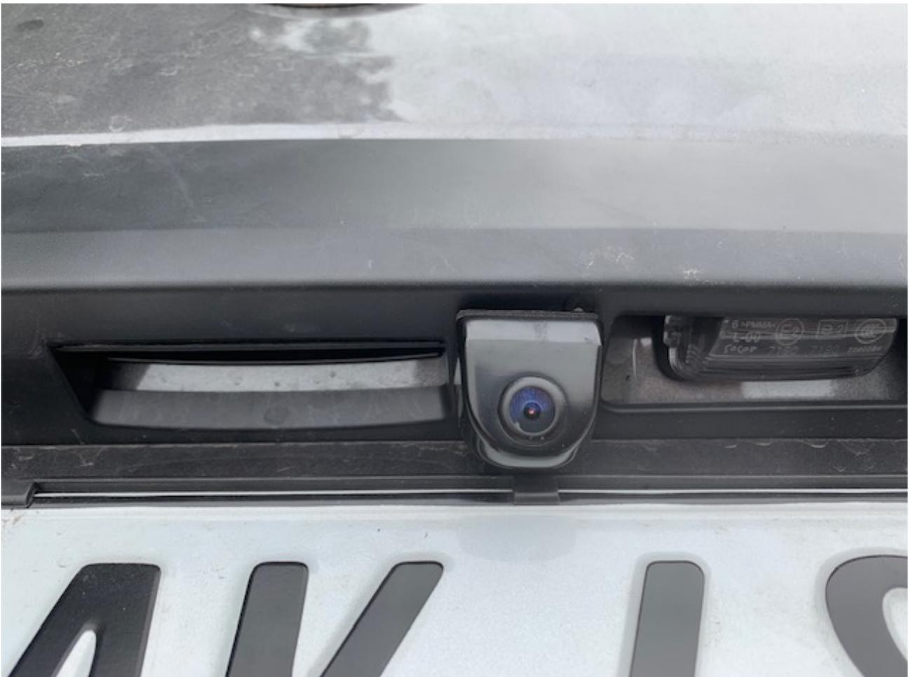
Verlegen Sie das Verlängerungskabel nun wie auf dem Bild zu sehen zu dem Kabelstrand, der in das Fahrzeug führt. Schließen Sie zusätzlich noch das blaue Kabel am Verlängerungskabel der Kamera an den Rückfahrcheinwerfer an.
