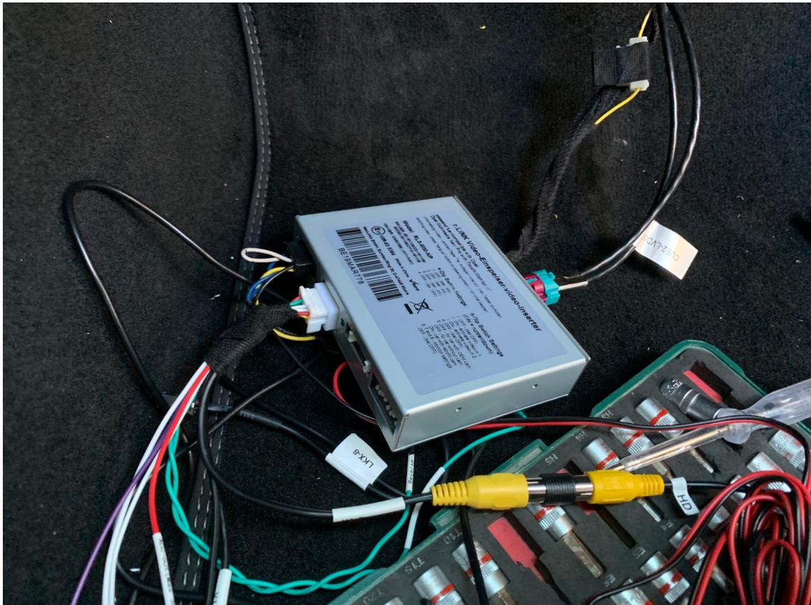
Das gelbe Videokabel wird an die entsprechende Videobuchse des Interface angeschlossen. Diese ist mit der Bezeichnung „V4 Reserve“ gekennzeichnet.
