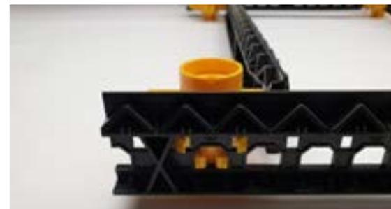
**5** Ajustez les grilles à la hauteur correcte à l'aide d'un laser, d'un bloc de réglage et d'un tournevis. Le réglage de la hauteur est possible à partir de 4,5 cm.
