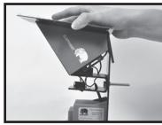
Vinkla solpanelsdelen från undersidan försiktigt framåt. Akta solpanelens kabel när du gör detta.
