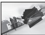
Nehmen Sie den Deckel von der Bodenplatte, achten Sie dabei auf das Kabel des Solarmoduls, dies bleibt mit der Bodenplatte verbunden!
