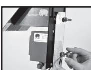
Befestigen Sie das Gehäuse mithilfe der beiden integrierten Bolzen auf dem mitgelieferten Ständer; dieser dient gleichzeitig als Erdstab für Ihr Weidezaungerät. Dazu ist das mitgelieferte Erdkabel am Ständer zu befestigen (siehe auch Erdung).
