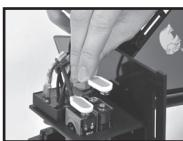
Setzen Sie 2 x \*9-Volt-Blöcke mit den (druckknopfförmigen) Kontakten nach oben in das Batteriefach ein. Verbinden Sie die beiden Batterieanschluss-Clips mit den Batterien, achten Sie dabei auf den Plus ⚡ und Minus-Pol ⚡ (\*siehe Kapitel 1. Verwendung von Batterien.)
