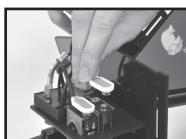
Sæt 2 x 9 volts\* batteriblokken i batteriholderen med (knap)kontakterne opad. Slut de to batteristik til batteriene. Vær opmærksom på Plus- og Min-polerne (\*se kapitel 1. Brug af batterier).
