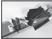
Ta bort basplattans skydd, akta solpanelens kabel, den sitter fast i basplattan!
