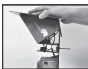
Neigen Sie den Deckel mit dem Solarmodul vorsichtig nach vorne, achten Sie dabei auf das Kabel des Solarmoduls.
