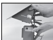
Plaats de kap met zonne-paneel weer terug op de basisplaat, en schuif de grendelclip weer terug in de 2 sleuven aan de achterzijde van de basisplaat.
