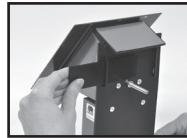
Verwijder de grendelclip op de achterzijde van de behuizing door deze zijwaarts uit te schuiven.
