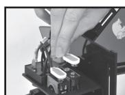
Placer 2 piles de \*9 Volt avec les contacts (pôles) vers le haut dans le compartiment de piles. Raccorder les fiches de pôles aux piles, en veillant à respecter la polarité Plus ☺ et Moins ☻ (\*voir chapitre 1. Utilisation des piles)
