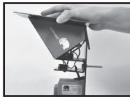
Vip kappen med solpanelet forsigtigt frem fra undersiden; vær opmærksom på kablet fra solpanelet.
