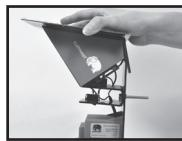
Basculer vers l'avant avec précaution le couvercle avec le panneau solaire à partir du bas, en faisant attention au câble du panneau solaire.
