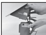
Sätt tillbaka solpanelsdelen på basplattan och skjut tillbaka låsclipset i de två skårorna på basplattans baksida.
