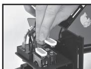
Plaats 2 x \*9Volt batterij-blok met de (knoop) contacten naar boven in de batterijhouder. Sluit beide batterij-knoopstekkers aan op de batterijen, let hierbij op Plus ⓠ en Min ⓡ (\*zie hoofdstuk 1. Gebruik batterijen).
