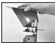
Kantel de kap met het zonnepaneel vanaf de onderzijde voorzichtig naar voren, let hierbij op de kabel van het zonnepaneel.
